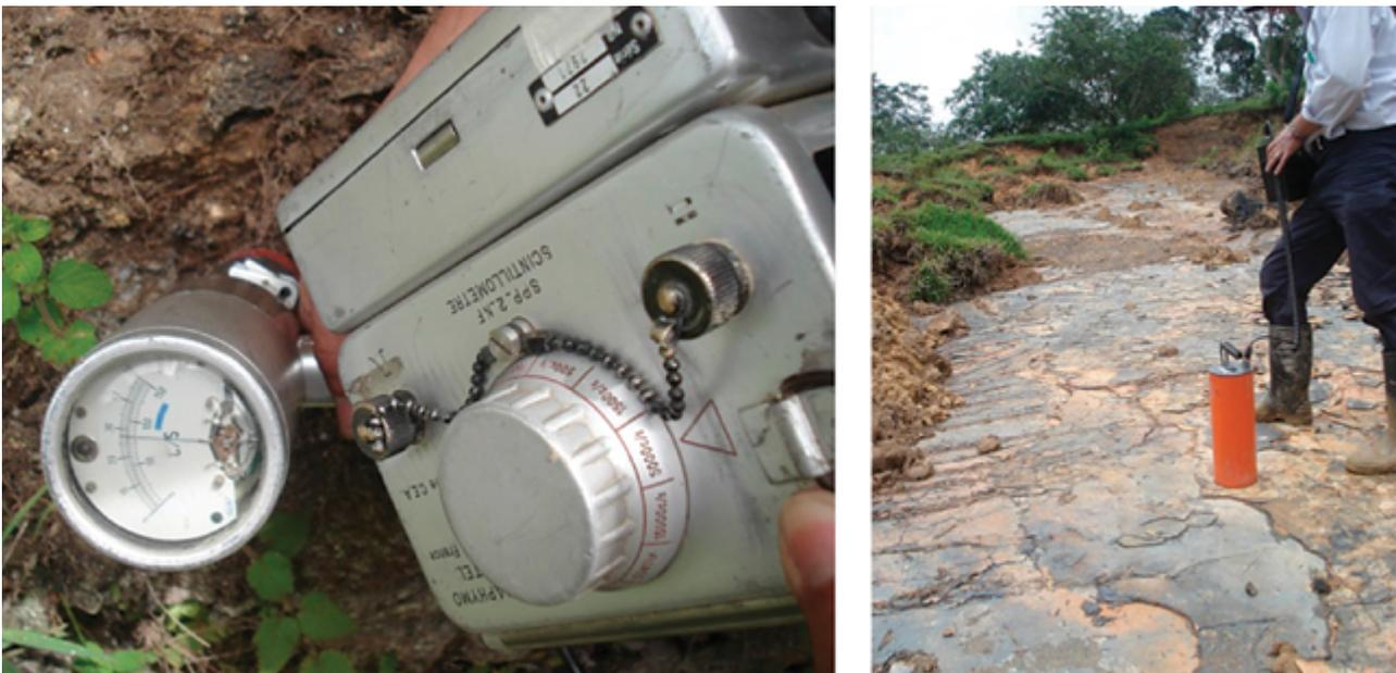
**Figura 3.** Centillómetro, spp2 2-NF (izquierda). Gamma espectrómetro GS-512 canales (derecha)
