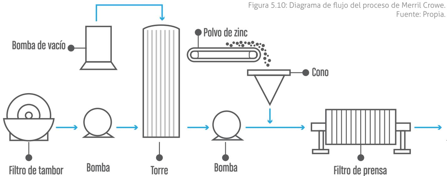
Figura 5.10: Diagrama de flujo del proceso de Merrill Crowe.
