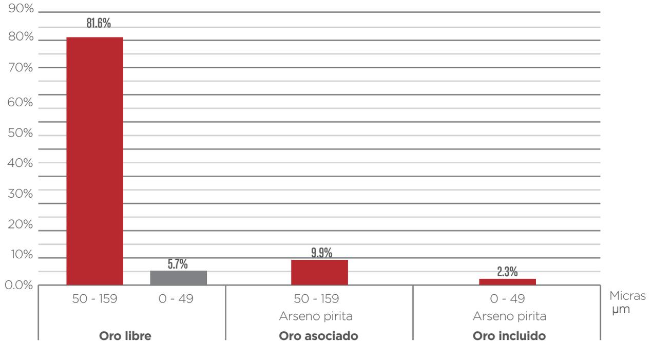
**LIBERACIÓN DE SULFUROS Y ORO EN MATERIAL DE CABEZA EN LA UNIDAD GEOMETALÚRGICA 2**
