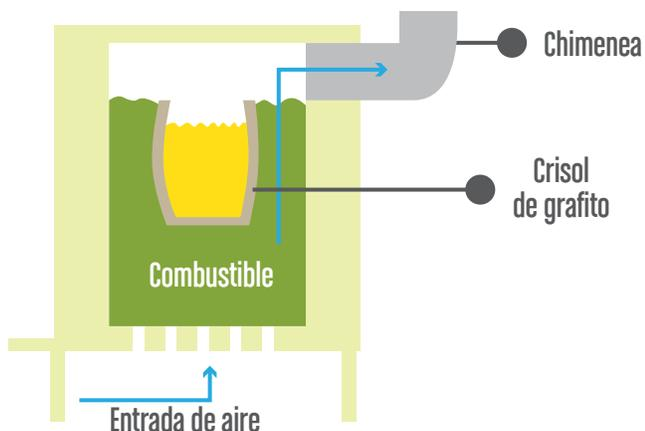
Fotografía 16: Modelo de horno con crisol.
