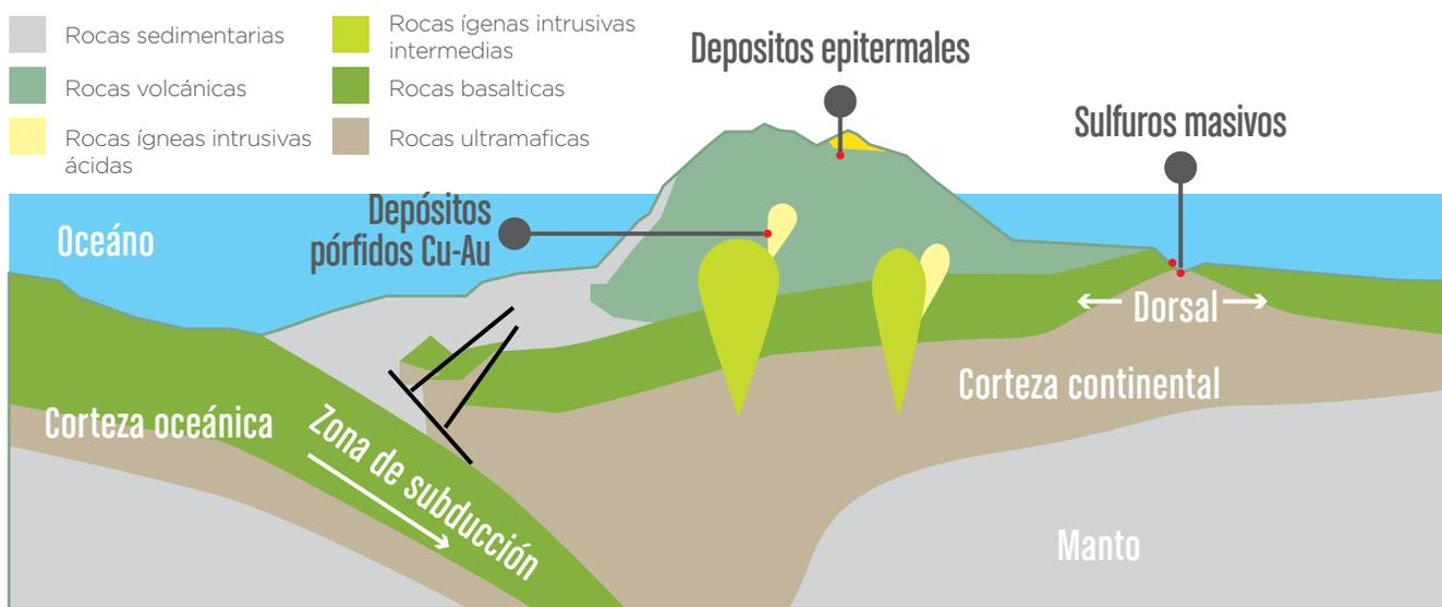
Figura 4.2: Perfil generalizado de la corteza terrestre indicando los principales elementos que intervienen en la formación de depósitos hidrotermales filonianos.
