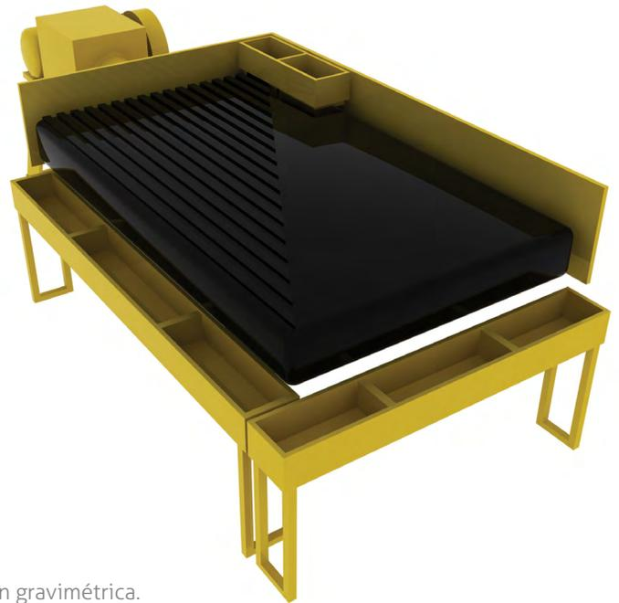
Figura 5.7: Diagrama de funcionamiento de una mesa de concentración gravimétrica.
