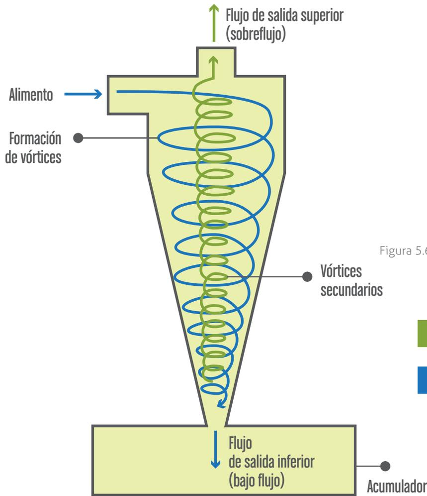
Figura 5.6: Diagrama de funcionamiento de un hidrociclón. Fuente: Propia.
