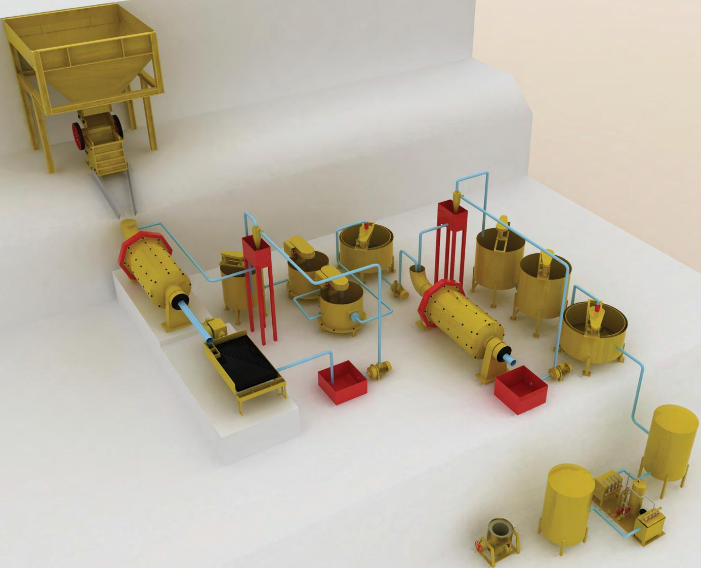
El siguiente gráfico muestra una aproximación a la configuración de la planta de beneficio que se requiere para seguir los pasos de la ruta metalúrgica sugerida. Además, incluye los equipos que componen la planta de beneficio actual. Se propone una adecuación que los incluya.
