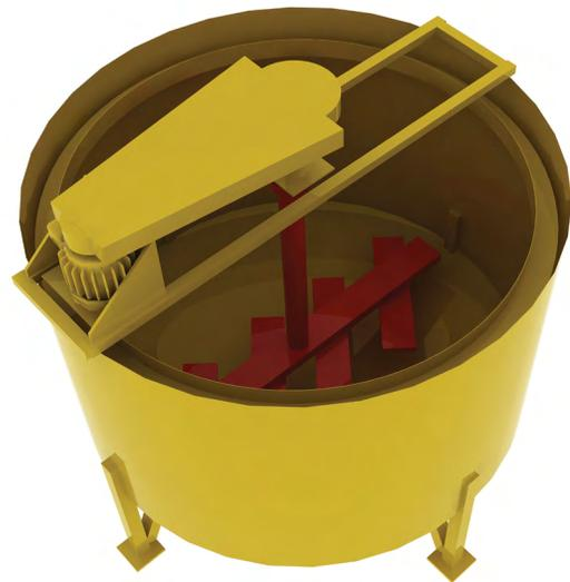
Figura 6.18. Diagrama de tanque espesador. Fuente: autores.
