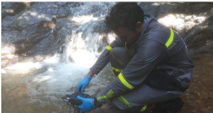
Fotografía 7.3. Medición de pH del agua en la quebrada el Hundidor aguas arriba del entable de beneficio. Fuente: autores.
