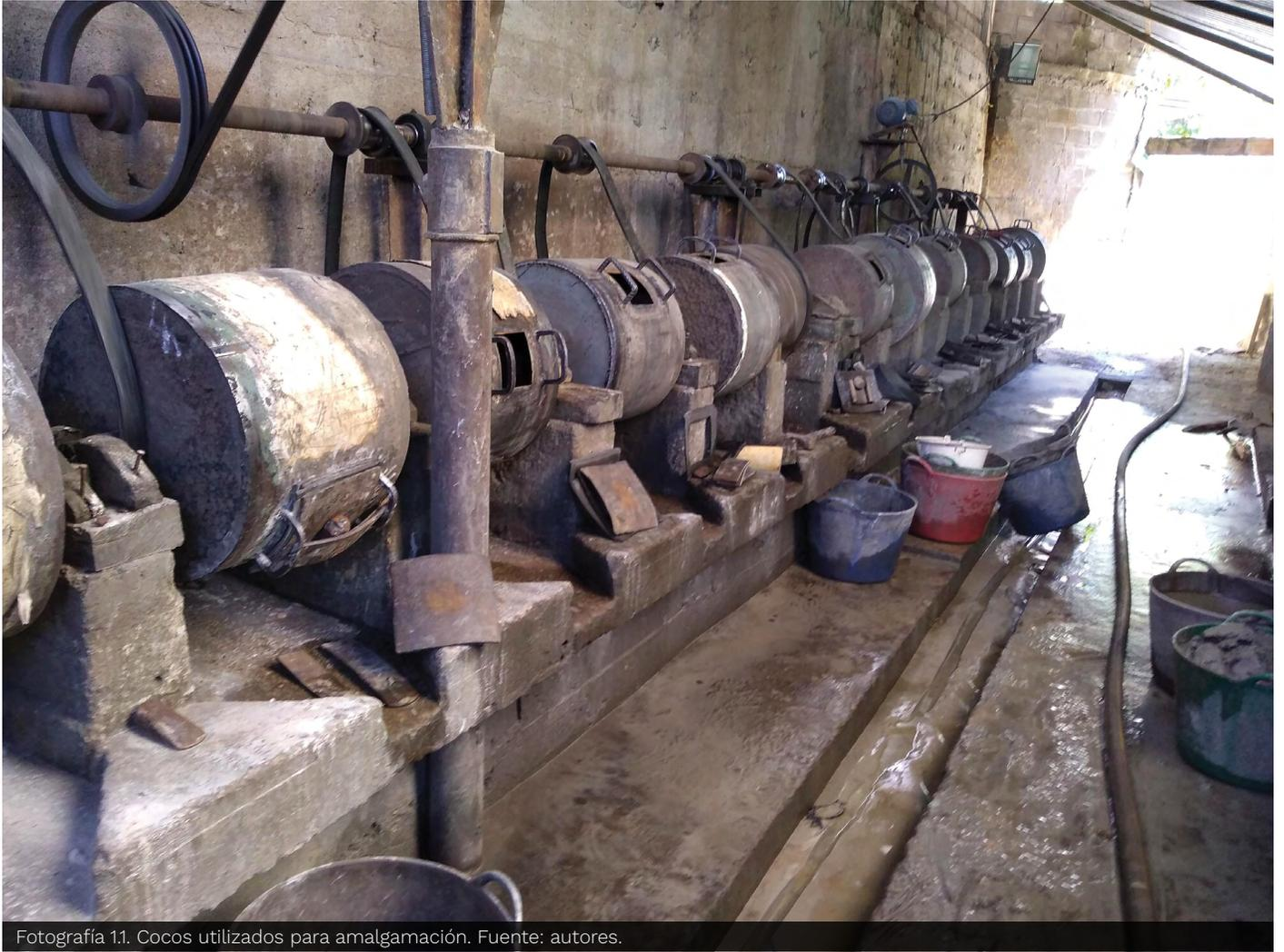
Fotografía 11. Cocos utilizados para amalgamación. Fuente: autores.
