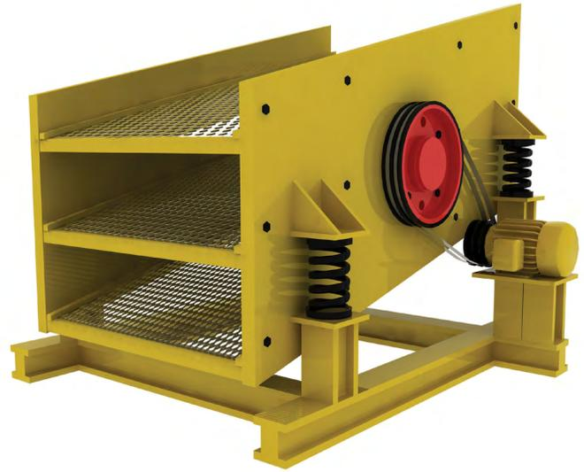
**Las cribas son útiles principalmente durante las etapas de trituración, en tamaño inferiores a 1/16", pierden su eficiencia debido al taponamiento.**
