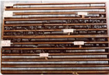
**Figura 1.** Núcleos de perforación exploratoria.
