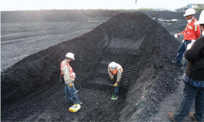
Proceso de toma de muestra y de densidad en pila
