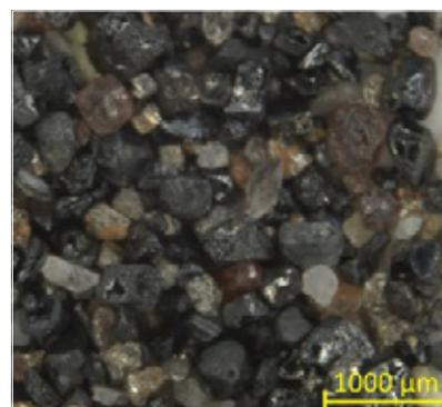
Fotografía 4.10. Minerales pesados, fracción de tamaño de 250-500 µm (Mina Coco-San José)
