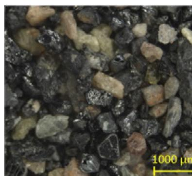
Fotografía 4.8. Minerales pesados, fracción de tamaño de 250-500 µm. Mina La Loma
