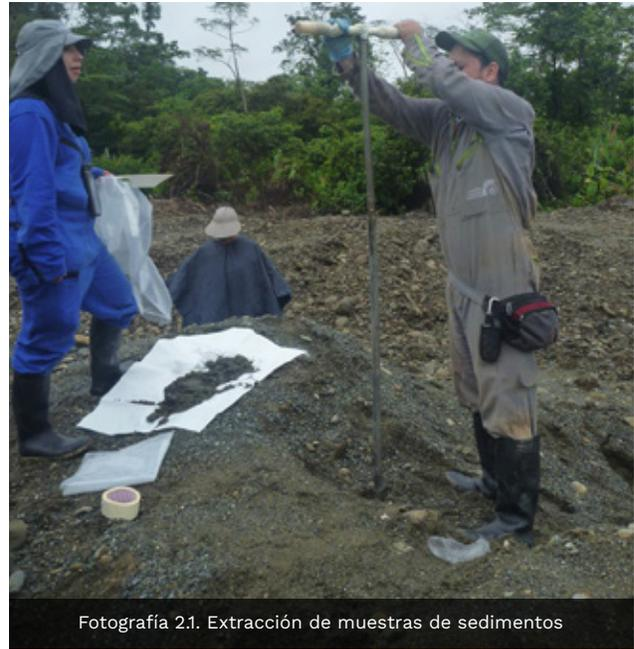
Fotografía 2.1. Extracción de muestras de sedimentos
