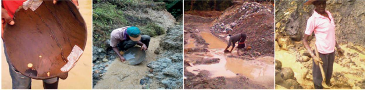
de procesos como el de agua chorreada, lavado con monitor o uso de minidraga, además de que se observó que se realiza como trabajo adicional en los procesos de extracción con retroexcavadora, específicamente en los sobrantes del material que se remueve y se descarga en las zarandas para el lavado y clasificación (fotografía 5.3). En ella se utilizan herramientas manuales: batea, barra, almocafre, cacho.
