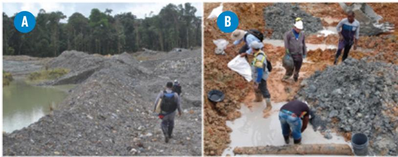
En la operación minera del sector se trabaja 1 turno de 10 h/día, siendo la capacidad de extracción de mineral de frente de mina alrededor de los 1000 m<sup>3</sup>/día, lo que equivale a remover por día cuadrantes de 20 m x 20 m, con 2,5 m de profundidad. El consumo de ACPM para la retroexcavadora es de 45 gal/día y la producción de oro es de 170 castellanos cada 15 días, lo que equivale a 52,1 g/día.
