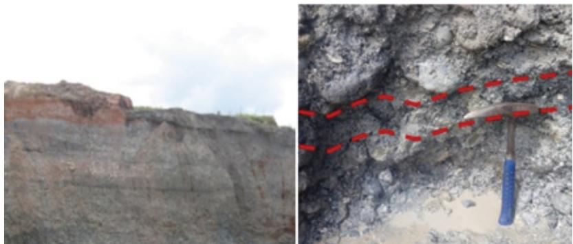
cm de profundidad, a través de la zona mineralizada. Cuando el venero es solo de algunos centímetros, se hace un canal a lo largo de la franja enriquecida hasta completar el volumen de muestra requerido.
