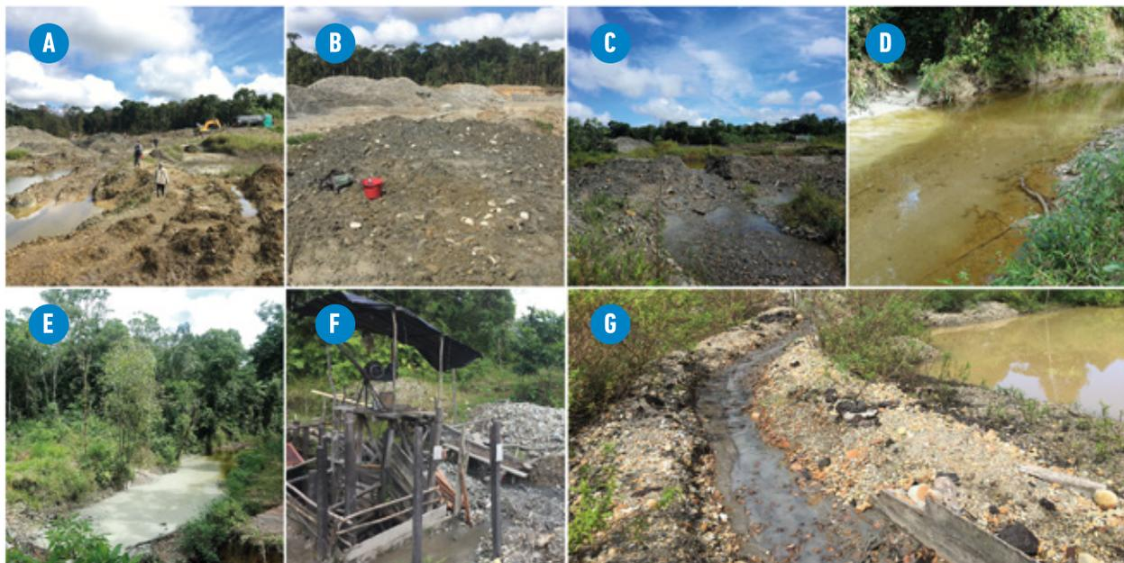
En la vereda La Toma también se llevó a cabo la visita a la mina Santa Rita, donde emplea como técnica de extracción aluvial un sistema de guaches, y el material que se obtiene de este proceso es lavado sobre paños, generando un vertimiento canalizado a un pozo de agua de lluvia que drena a la quebrada Santa Rita, razón por la cual se tomó una muestra del vertimiento en un punto previo a la unión con el agua del pozo.
