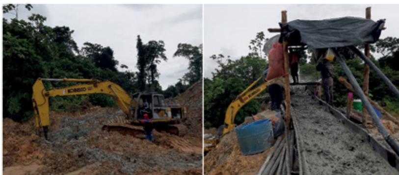
Por ejemplo, la minería a cielo abierto (fotografía 5.1) comprende las actividades y operaciones mineras desarrolladas en superficie para extracción del mineral, mientras que la minería aluvial de oro extrae el mineral depositado en terrazas aluviales, playas, barras y cauces de ríos.
