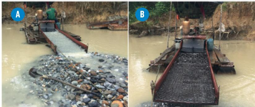
Fotografía 5.5. Explotación con elevadora, utilizada para extracción de material grueso
