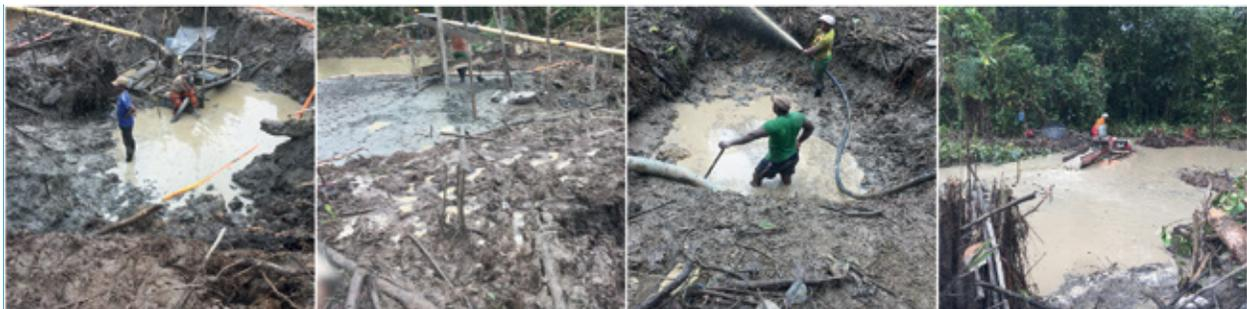
El proceso consiste en la remoción de agua y material de suelo y arenas, con ayuda de una persona que se sumerge en el fondo del cauce (buzo) y se encarga de posicionar la manguera para que la motobomba succione el material y lo deposite en un canalón, a fin de atrapar el oro por gravedad. Se realiza en los
