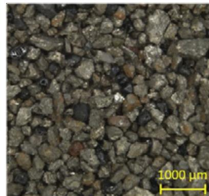
Fotografía 4.5. Minerales pesados, fracción de tamaño de 250-500 µm (Mina La Toma)
