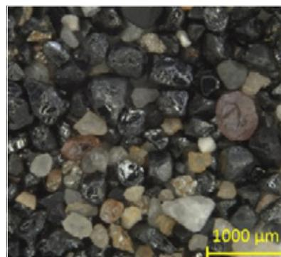
Fotografía 4.7. Minerales pesados, fracción de tamaño de 250-500 µm (Mina Carmelo)
