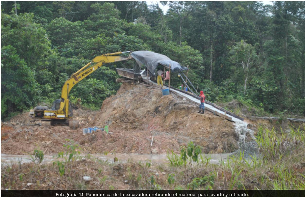
Fotografía 1.1. Panorámica de la excavadora retirando el material para lavarlo y refinarlo.
