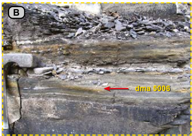
Figura 44. A) Se observa mudstone calcáreo con materia orgánica (metro 99-110); la parte superior del recuadro está ampliada en la fotografía inferior. B) Nótese las alternancias de láminas muy finas de color gris oscuro y blanco; por meteorización, estas láminas toman tonos pardos y amarillentos ( dma 5006 ) (metro 100, \Delta 79 ).
