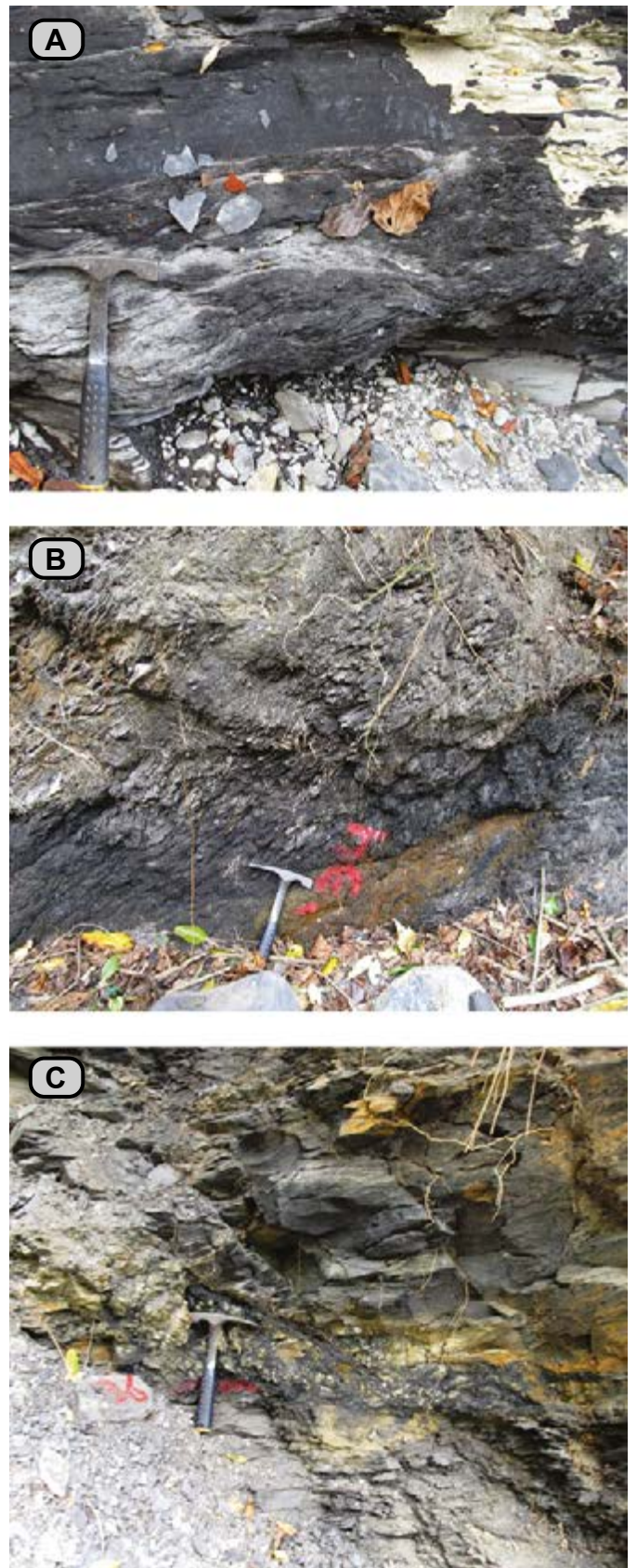
Figura 81. Mudstone arcilloso calcáreo con deformación localizada: A) Deformación señalada por el martillo, se aprecian 30 cm con láminas retorcidas (metro 260). B) Segundo tramo deformado; la roca se observa finamente fracturada y deleznable (metro 266). C) Brecha en franja oblicua al S_0 ; la roca está triturada en fragmentos angulares de hasta de 3 cm (metro 266).
