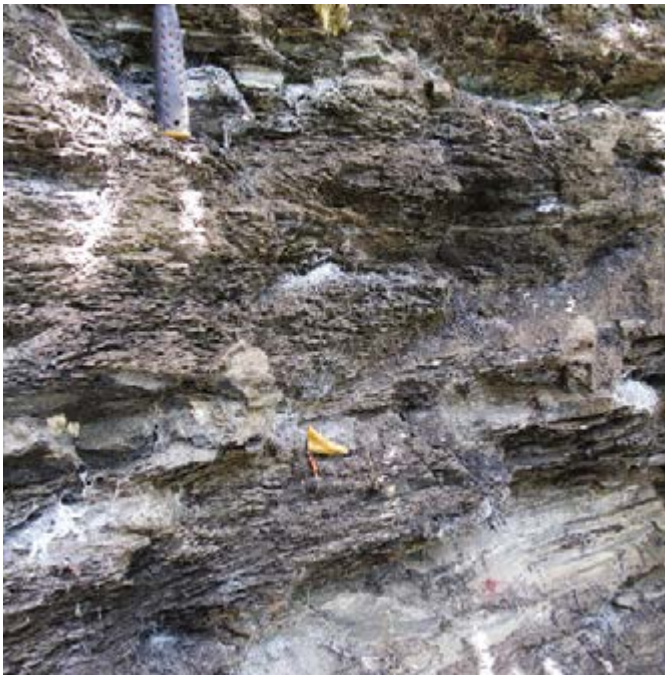
Figura 30. Intervalo de mudstone arcillosos calcáreos laminados con materia orgánica. Nótase la partición en lajas (metro 85, Δ92).
