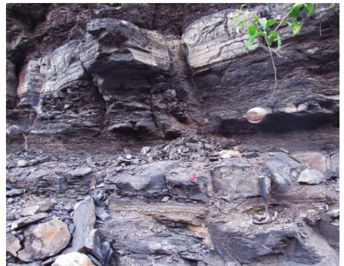
Figura 113. Mudstone calcáreos con materia orgánica, grises, laminados, con presencia de lentes y láminas de calcita fibrosa (metro 100-102); alternan con capas delgadas de caliza mudstone de forma arrosariada.
