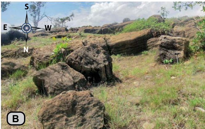
Figura 13. Miembro Zo de la Formación Rosa Blanca. (A) Aspecto morfológico (N:1.251.314, E:1.091.317, Z:1.534). (B) Capas tabulares gruesas de biomicritas- packstone (N:1.252.120, E:1.092.524, Z:1.556). (C) Biomicritas- packstone con laminación inclinada (N:1.252.032, E:1.092.541, Z:1.562).
