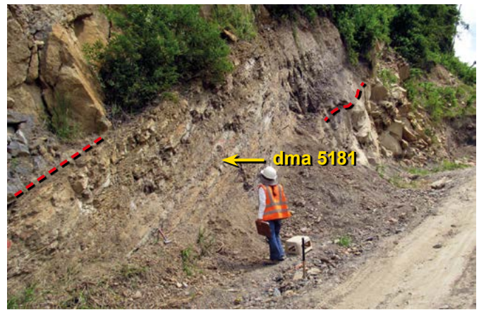
Figura 115. Conjunto P2, delimitado ente líneas rojas punteadas; hacia la base se trata de mudstone arcillosos grises que gradan a limolitas de cuarzo y se disponen en capas delgadas, con laminación plana paralela; en ocasiones, las capas están bioturbadas (metros 234 a 240).
