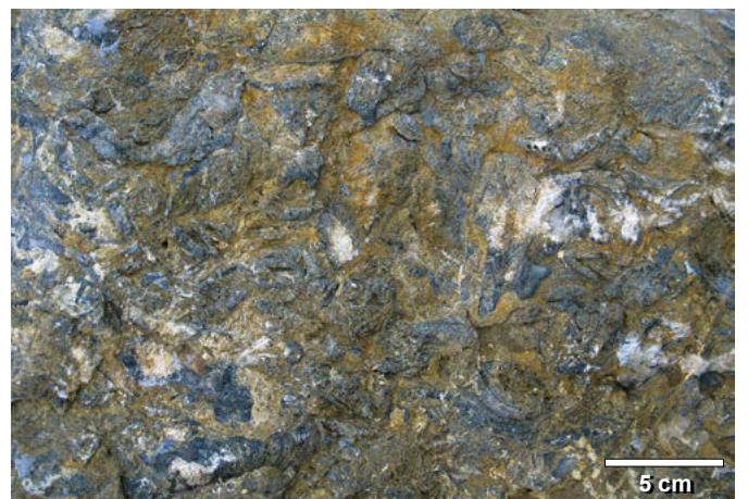
Figura 73. Techo del conjunto J3: caliza packstone con bivalvos grifeidos gris azulosos, articulados y desarticulados. Entre ellos se observa lodo calcáreo de tono pardo.
