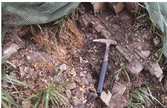
Figura 52. Parte superior del segmento 10; capa mediana de fosforita (parte central de la fotografía) con textura packstone , de color naranja muy pálido, en avanzado estado de meteorización; Formación La Renta, m292,0-m292,3 (N:1.263.731, E:1.076.202, Z:448, Az:270°). Escala: longitud del martillo = 33 cm.
