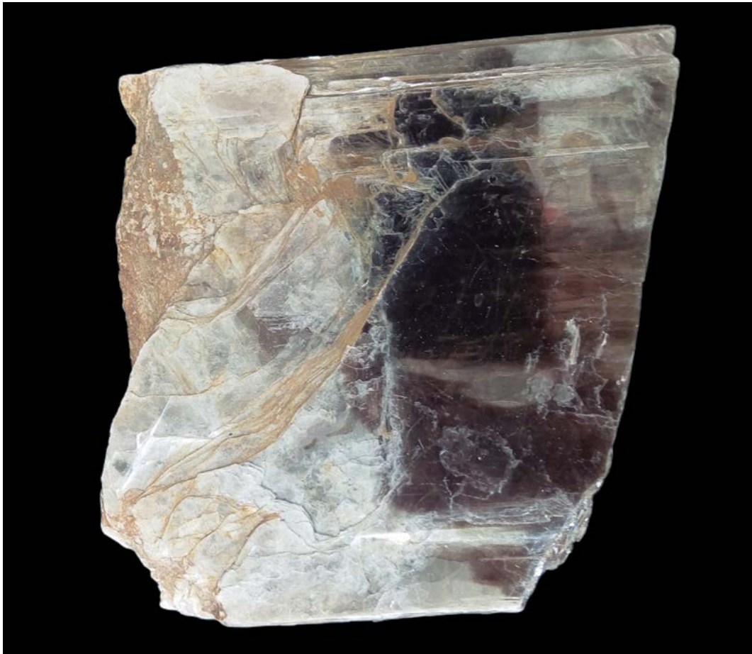
51 Mineral moscovita Se aprecia su forma de romperse en una dirección definida, en un solo plano Fuente: www.ericca.es
