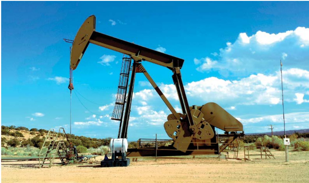
121 Balancín o machín, utilizado en la industria del petróleo para extraerlo del subsuelo Fuente: Agencia Nacional de Hidrocarburos (2009)
