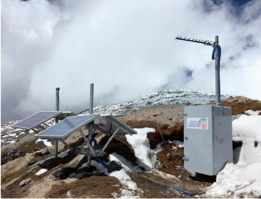
**Figura 8.** Estación multiparamétrica Nereidas, Es la de mayor altitud, ubicada a 5.098 m.s.n.m. Cuenta con un sismómetro de banda ancha
