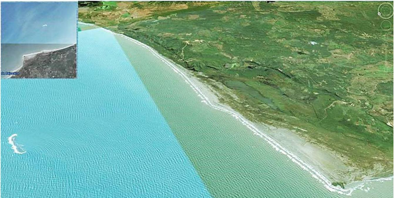
**Figura 22.** Vista panorámica hacia el E en el sector de isla Cascajo. Nótese los procesos de difracción del oleaje y el efecto de sombra generados por la isla Arena, lo cual facilita los acrecimientos de arena de playa hacia la isla.
