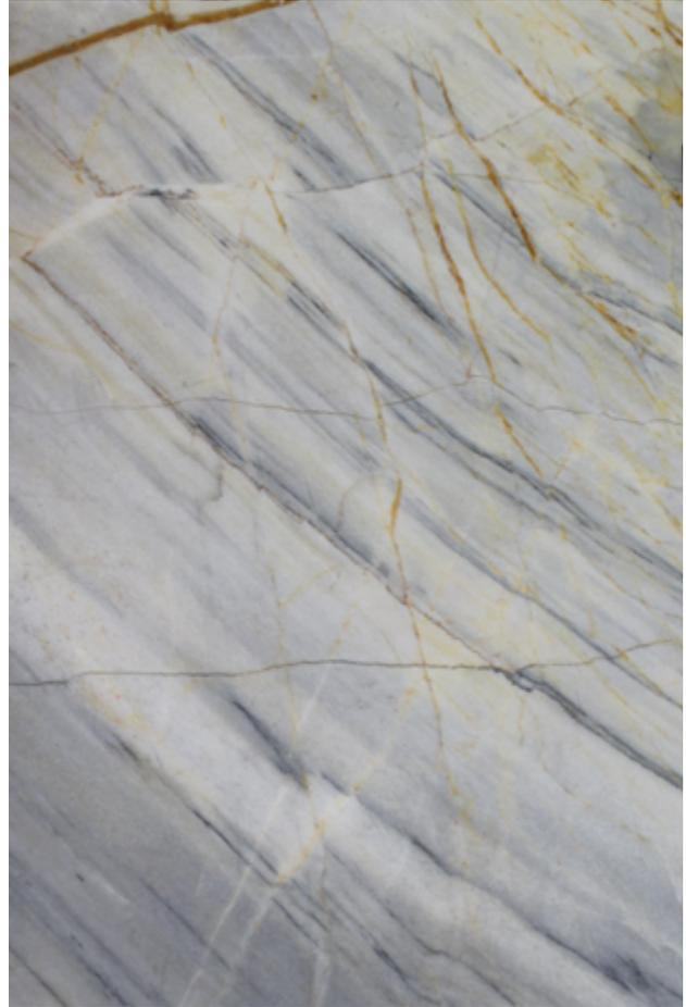
**Figura 3.** Ejemplo de mármol metamórfico
