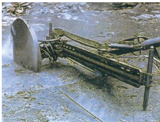
**Figura 13.** Fotografía de corte con rozadora de brazo
