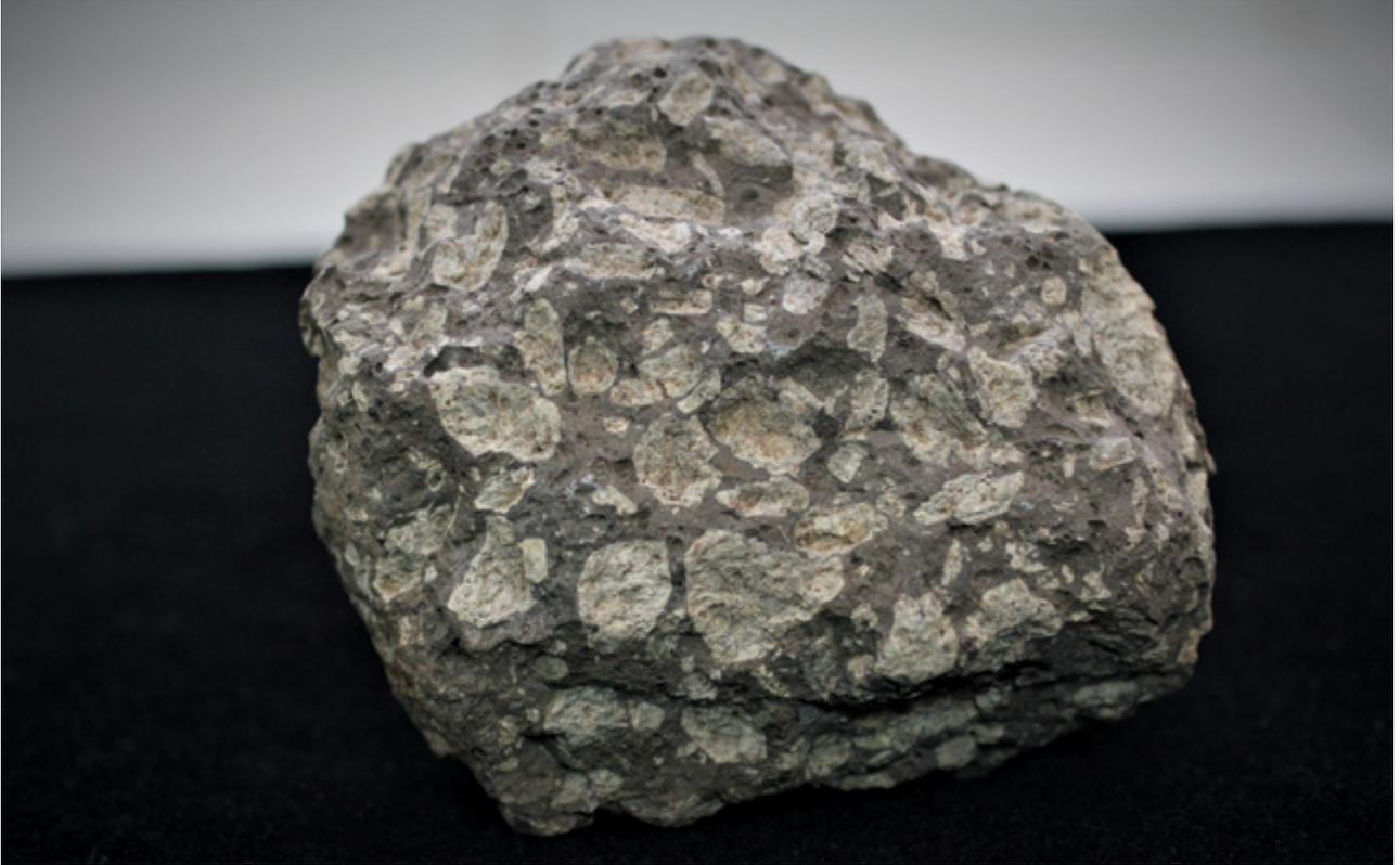
**Figura 8.** Rocas ígneas extrusivas (andesita), utilizadas como rocas ornamentales
