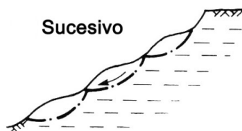
Figura 7. Deslizamiento rotacional sucesivo.
