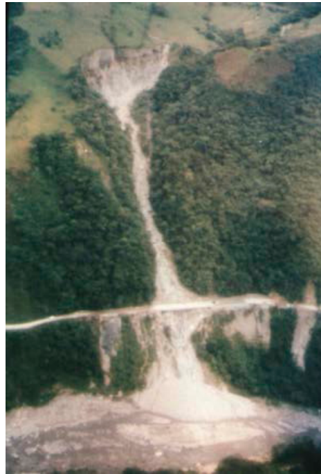
Fotografía 22. Flujo de detritos de la quebrada Corrales.
