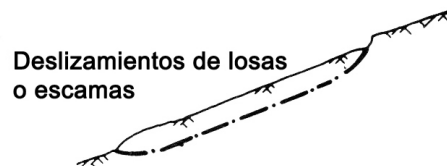
Figura 10. Deslizamiento traslacional de losas o escamas.
