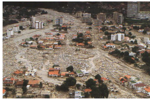
Fotografía 9. Flujos de detritos depositados en el abanico de Caraballeda, estado Vargas (Venezuela), durante el evento catastrófico ocurrido los días 15 y 16 de diciembre de 1999.
