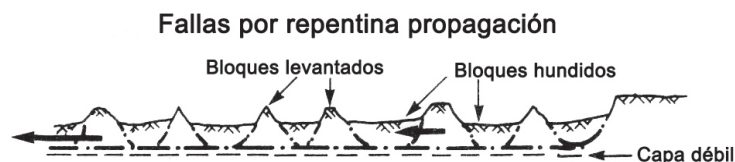
Figura 13. Falla por propagación repentina.
