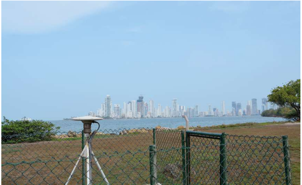
Estación GNSS (Global Navigation Satellital System) permanente de operación continua instalada en el Centro de Investigaciones Oceanográficas e Hidrográficas (CIOH) de la DIMAR en la ciudad de Cartagena. Red Nacional de Estaciones Geodésicas Espaciales GNSS con propósitos geodinámicos (GeoRED).
