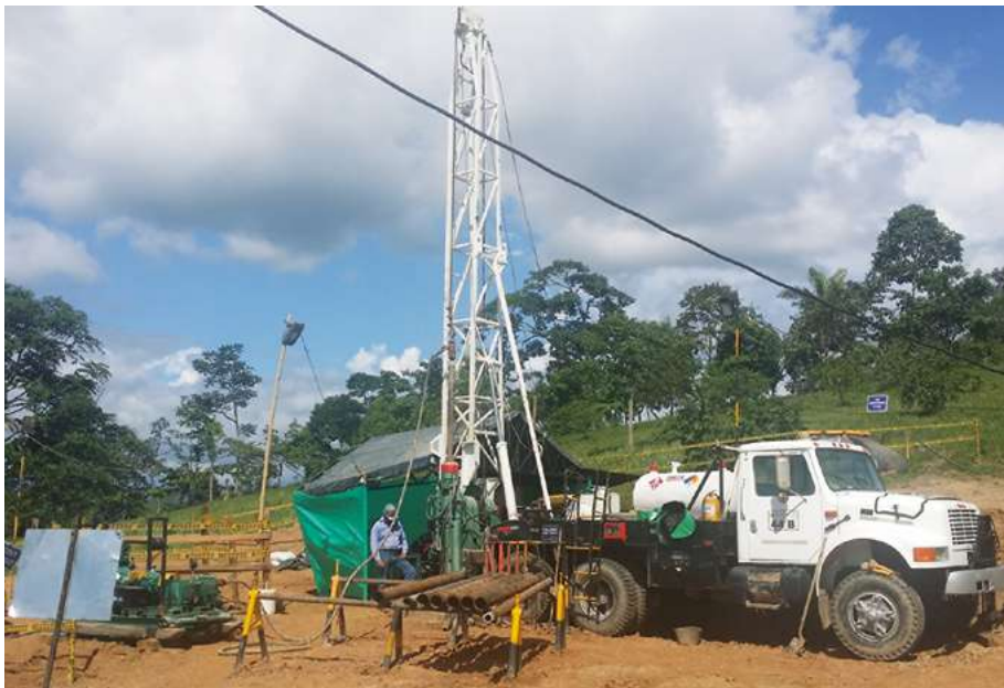
Perforación del pozo El Carmen de Chucurí 1 y muestreo de carbones para medición de contenido de gas metano. Municipio de El Carmen de Chucurí, Santander (2015).
