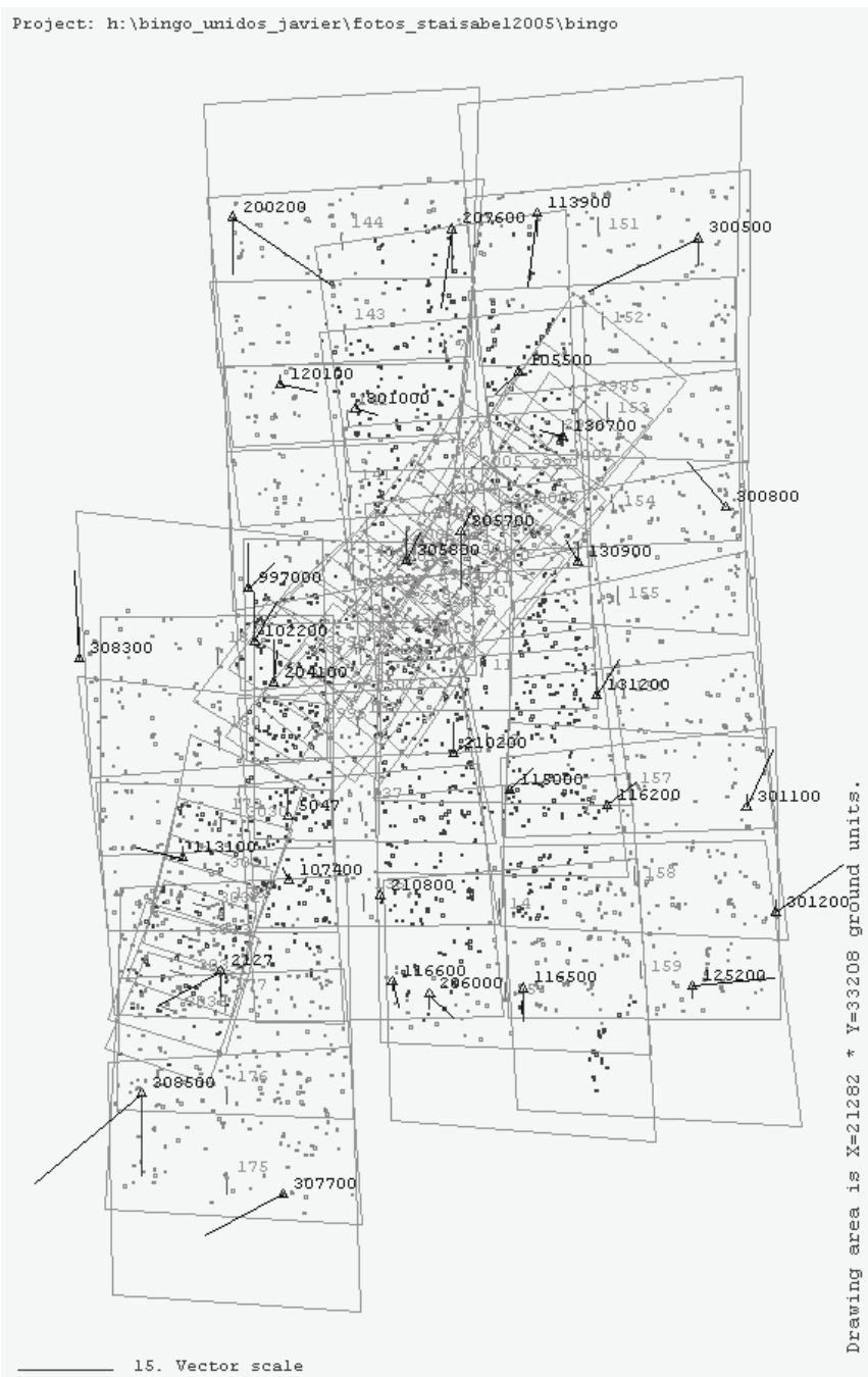
Figura 2. Aerotriangulación conjunta de 1987 y 2005 en Bingo para los nevados del Ruiz y Santa Isabel.
