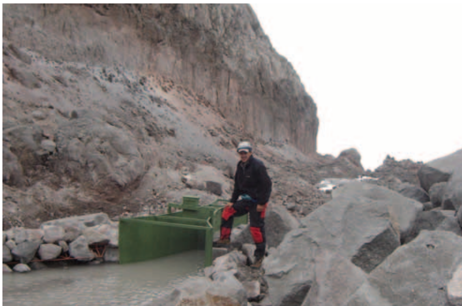
Figura 8. Canaleta tipo Parshall cerca del glaciar Conejeras.
