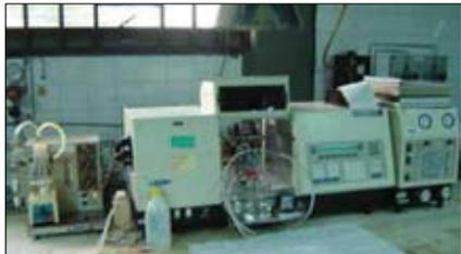
**Figura 8.1.** Unidad generadora de vapor frío de mercurio acoplada al espectrofotómetro de absorción atómica Shimadzu AA 660 V4.
