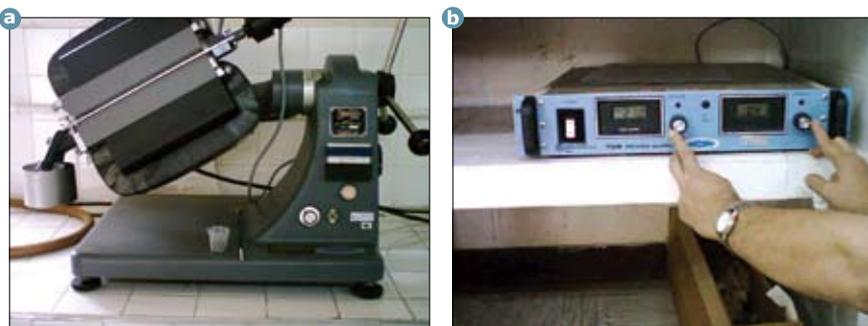
**Figura 4.13.** Separador magnético Isodymanic Frantz: **a.** Separador magnético. **b.** Regulador de corriente y voltaje eléctricos.
