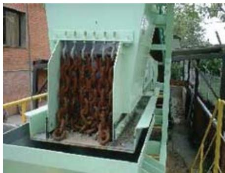
Figura 1.3. a. Tolva de almacenamiento. b. Alimentador vibratorio
