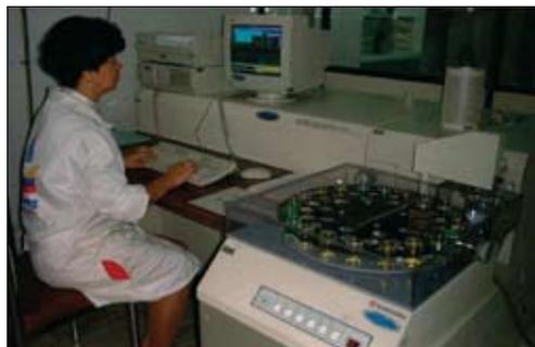
**Figura 14.1.** Espectrómetro marca Shimadzu, modelo ICP-AES 1000 IV
