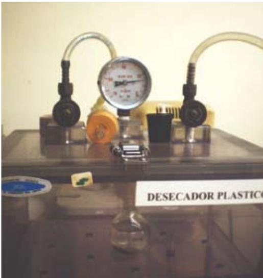
**Figura 11.3.** Extracción de aire por vacío.
