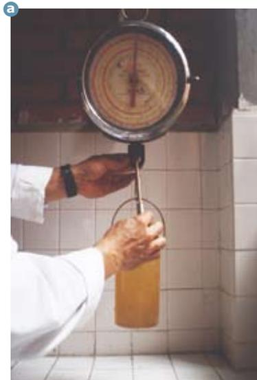
Figura 11.7. a. Calibración de la balanza Marcy.
