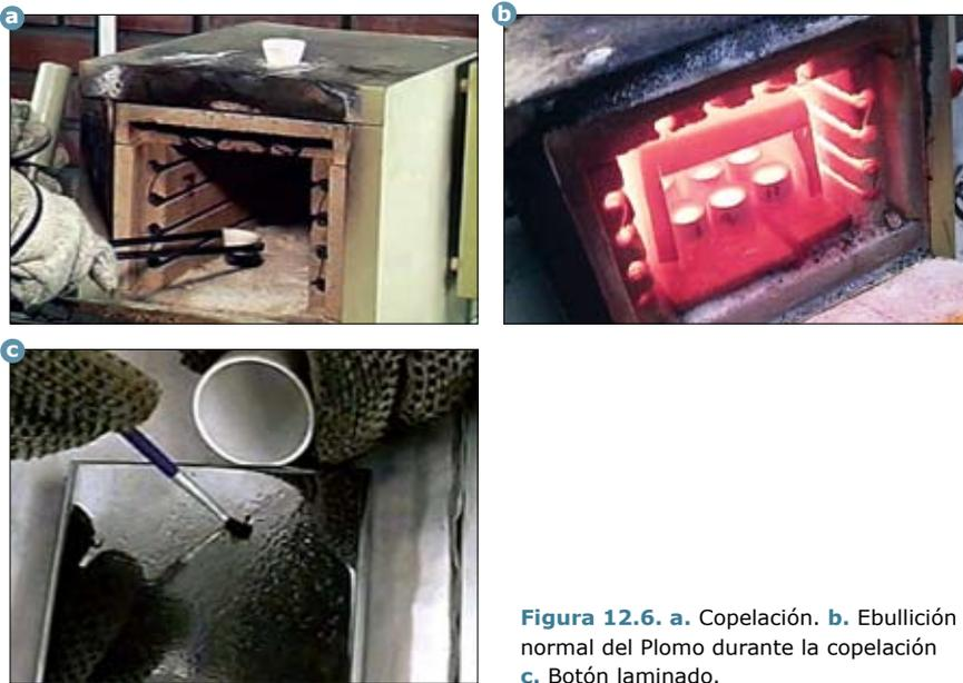
**Figura 12.6.** a. Copelación. b. Ebullición normal del Plomo durante la copelación c. Botón laminado.
