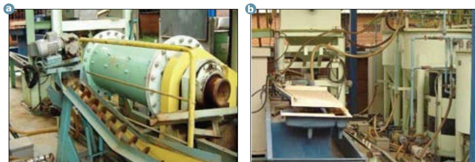
Figura 3.3. Circuito molino, clasificador, sedimentador, bomba, mesa.
