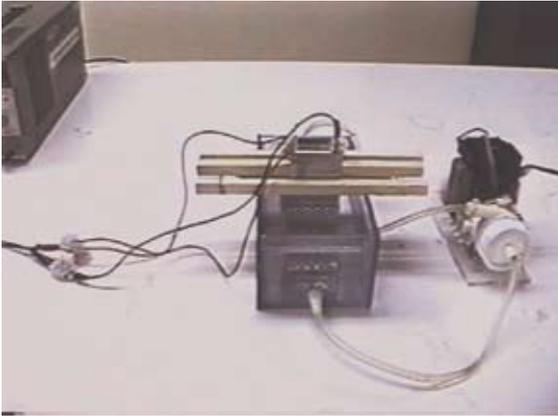
**Figura 10.9.** Equipo de electroobtención.
