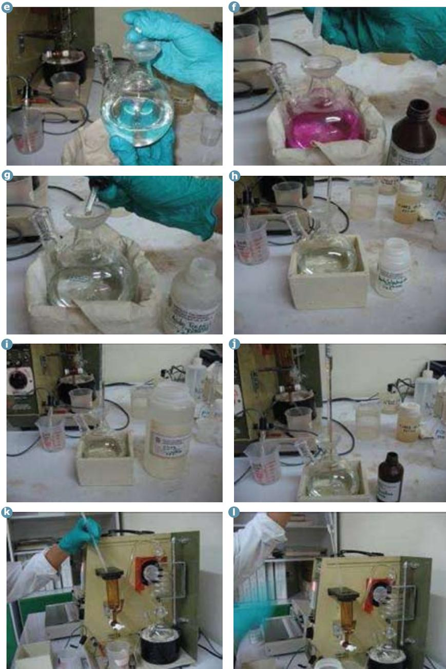
**Figura 10.3 . e.** Adición de piedritas de ebullición. **f.** Adición de indicador fenolftaleina. **g.** Adición de ácido fosfórico. **h.** Adición de 1 mL de amido sulfato de amonio al 10%. **i.** Adición de 5 mL de ácido L-ascórbico al 10%. **j.** Adición de 10 mL de ácido etilendiaminotetracético al 10%. **k.** Adición de acetato de plomo al 10%. **l.** Adición de hidróxido de sodio al 10%.
