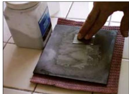
**Figura 4.4.** Corte de roca hasta 1 mm de espesor.
