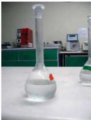
**Figura 3.7.** Estándar para calibración. Se observan las dos fases en solución. Se realiza teniendo en cuenta el mismo proceso al que se sometió la muestra problema.
