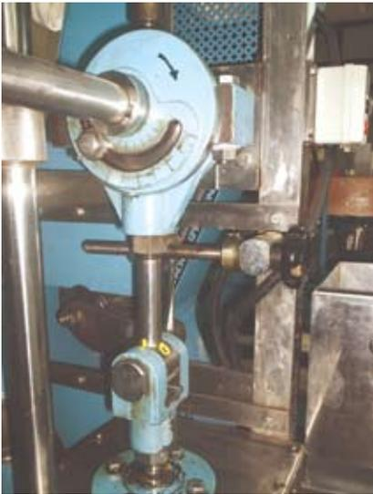
**Figura 6.4.** Excéntrica de amplitud de pistón.
