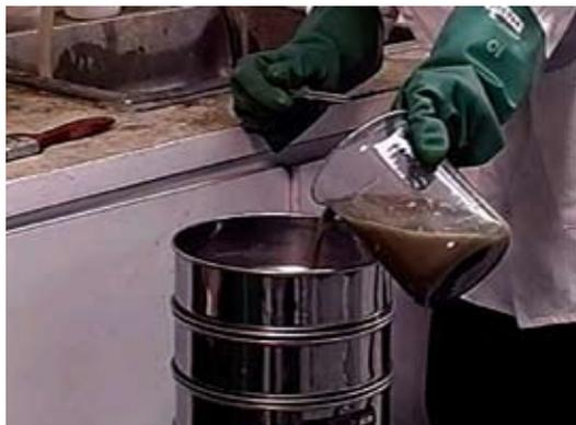
**Figura 3.2.** Clasificación por vía húmeda.
