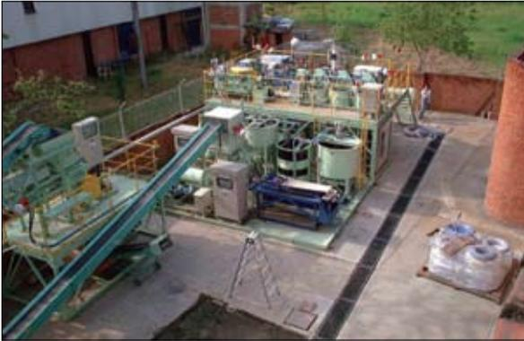
**Figura 2.8.** Banda alimentadora a tolva del molino.
