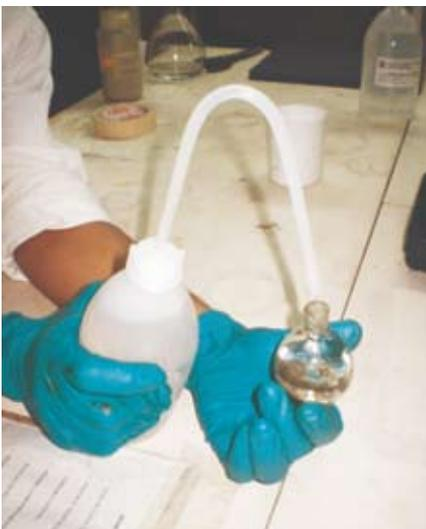
**Figura 11.4.** Llenado del picnómetro con líquido.
