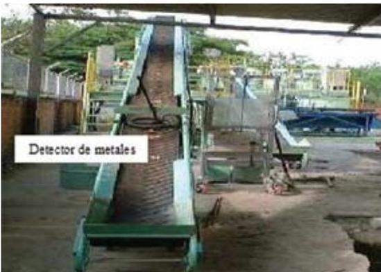
**Figura 1.2.** Banda alimentadora BC-A101 y detector de metales.
