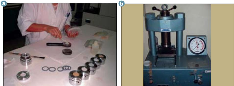
**Figura 2.2. a.** Montaje de muestra para la elaboración de pastilla en el soporte. **b.** Equipo prensa-preparación de pastillas.
