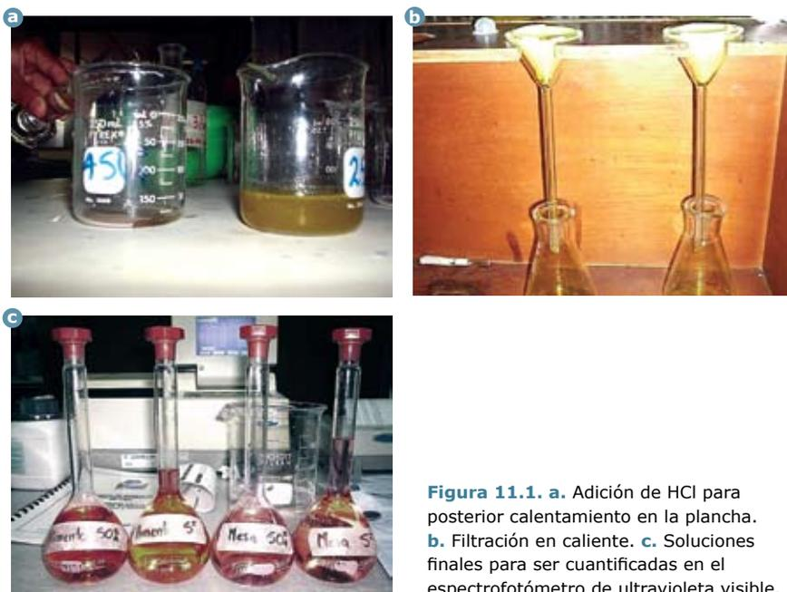
**Figura 11.1.** a. Adición de HCl para posterior calentamiento en la plancha. b. Filtración en caliente. c. Soluciones finales para ser cuantificadas en el espectrofotómetro de ultravioleta visible.
