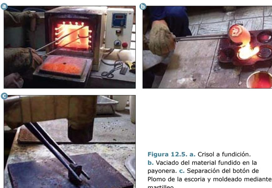
**Figura 12.5.** a. Crisol a fundición. b. Vaciado del material fundido en la payonera. c. Separación del botón de Plomo de la escoria y moldeado mediante martilleo.
