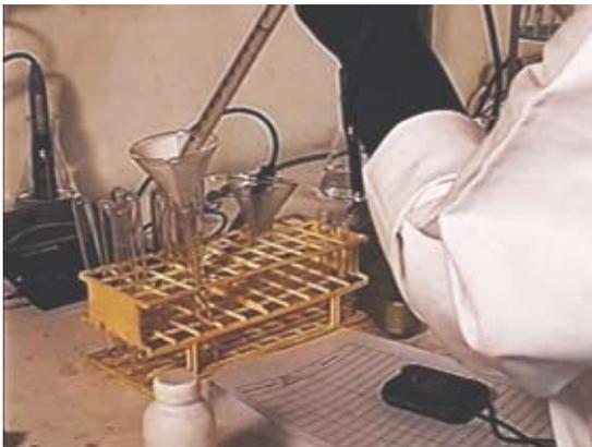
**Figura 9.5.** Toma de solución de cianuración con pipeta.
