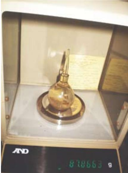
Figura 11.5. Peso del picnómetro lleno.
