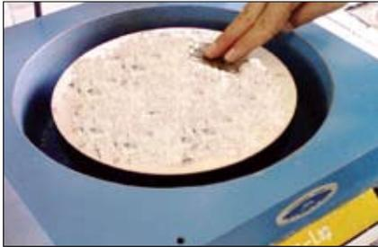
Figura 4.6. Pulido de la sección.
