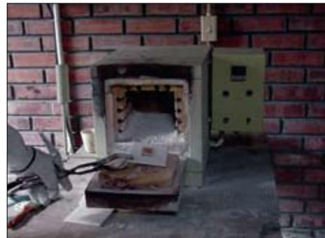
**Figura 4.21.** Calentamiento de la muestra orientada a 500 °C.
