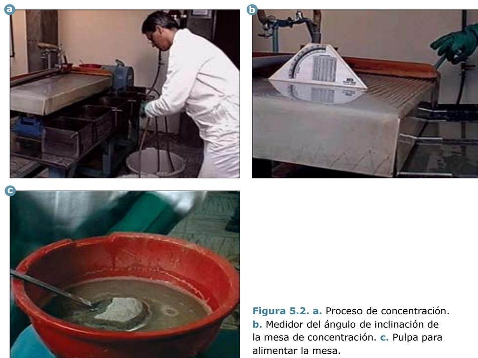
**Figura 5.2.** a. Proceso de concentración. b. Medidor del ángulo de inclinación de la mesa de concentración. c. Pulpa para alimentar la mesa.
