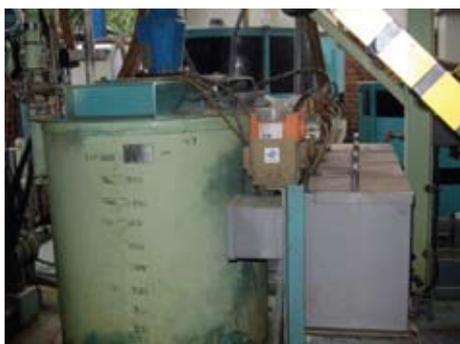
**Figura 8.1.** Unidad de tratamiento de la pulpa residual del proceso de beneficio.
