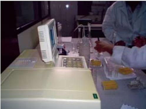
**Figura 11.3.** Cuantificación de soluciones en el espectrofotómetro UV-Vis.
