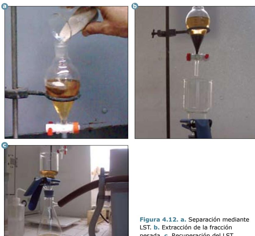
**Figura 4.12.** a. Separación mediante LST. b. Extracción de la fracción pesada. c. Recuperación del LST.
