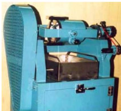
**Figura 2.1.** Molino de bolas del laboratorio de Ingeominas-Cali.
