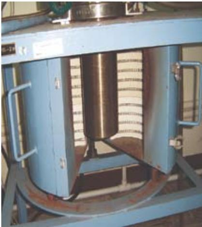
**Figura 8.3.** Recipiente de reacción y resistencias.
