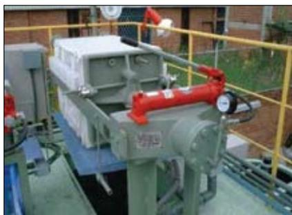
Figura 6.1. Filtro prensa de la planta piloto.
