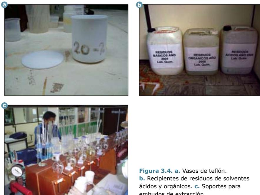
**Figura 3.4.** a. Vasos de teflón. b. Recipientes de residuos de solventes ácidos y orgánicos. c. Soportes para embudos de extracción.
