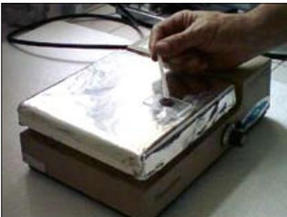
**Figura 4.7.** Adición de resina epóxica sobre la muestra.
