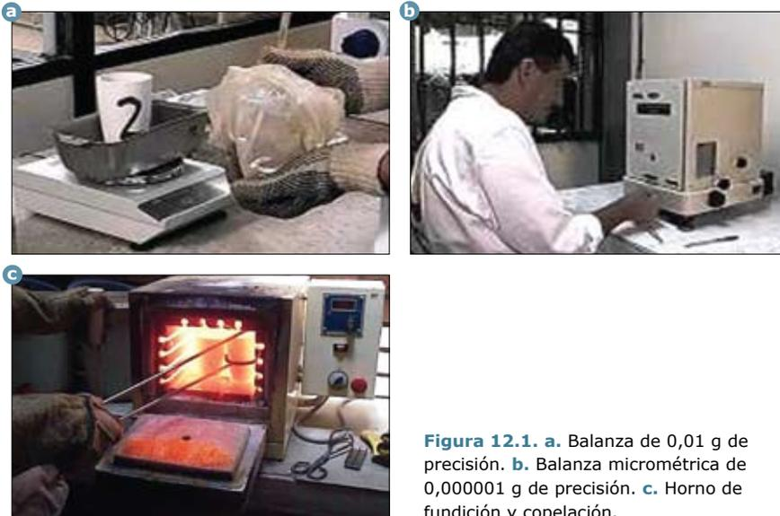
**Figura 12.1.** a. Balanza de 0,01 g de precisión. b. Balanza micrométrica de 0,000001 g de precisión. c. Horno de fundición y copelación.
