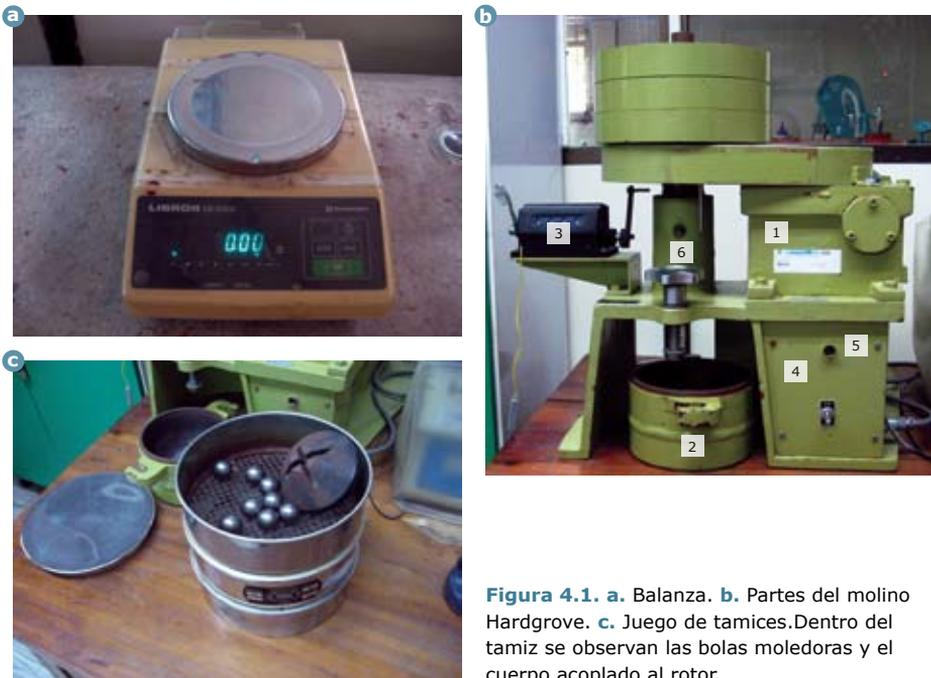
**Figura 4.1.** a. Balanza. b. Partes del molino Hardgrove. c. Juego de tamices. Dentro del tamiz se observan las bolas molidoras y el cuerpo acoplado al rotor.
