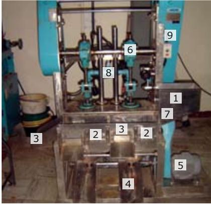
**Figura 6.2.** Partes del Harz JIG.
