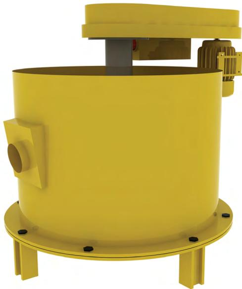
La flotación espumante se basa en la capacidad que posee la superficie de un sólido para ser humectado o no por el agua. Cuando dicho sólido permite ser humectado se dice que es hidrofílico (adsorbe agua en su superficie), mientras que si no se deja mojar es hidrofóbico; al introducir estos últimos minerales en agua sus superficies no formarán enlaces con los grupos polares, por ende, en presencia de una burbuja que asciende, estos se adhieren y la acompañan a flotar hacia la superficie.
