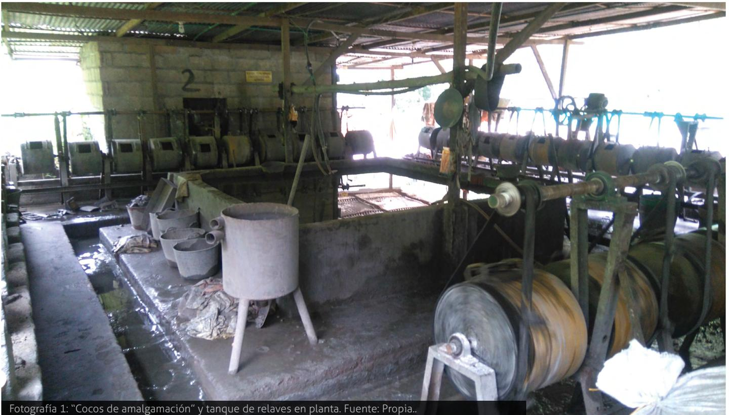
Fotografía 1: "Cocos de amalgamación" y tanque de relaves en planta. Fuente: Propia..
