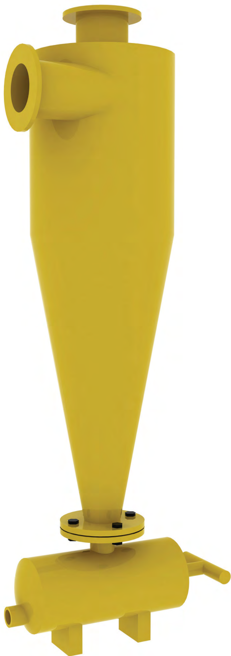
Fotografía 9: Modelo de hidrociclón. Fuente: Propia.
