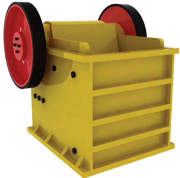
Fotografía 5: Modelo de trituradora de quijadas. Fuente: Propia..
