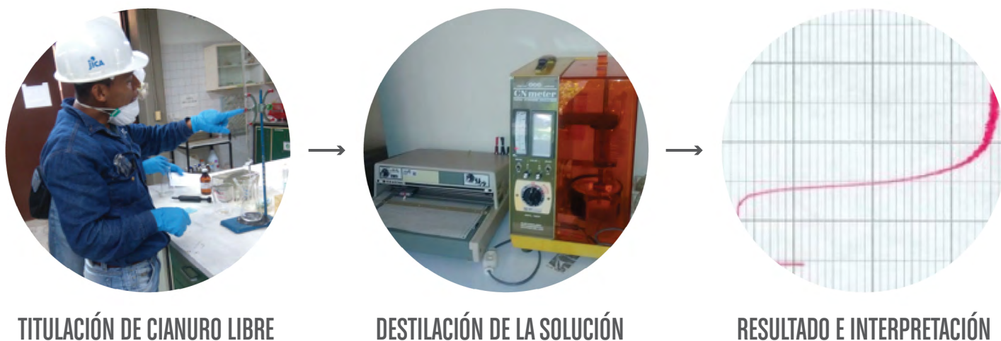
Figura 6.4: Determinación de cianuro total en una solución residual. Fuente: Propia.
