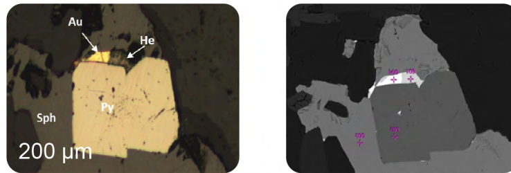
Microfotografías en microscopio óptico y composicional con la ubicación del punto analizado para identificar los cristales de Hessita (He) y oro (Au), asociados a pirita (Py) y Sph (esfalerita).
