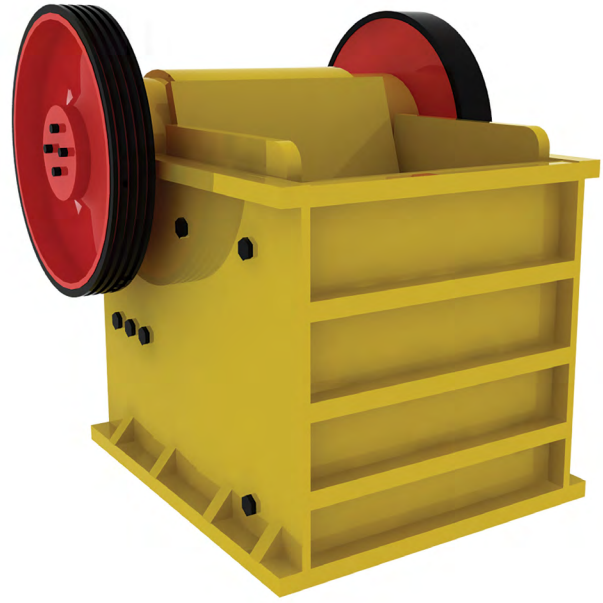
Fotografía 7: Modelo de trituradora de quijadas. Fuente: Propia.
