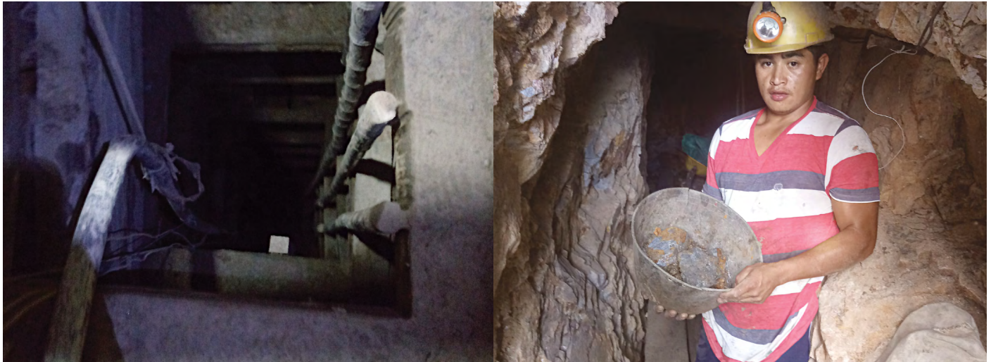
Fotografía 5.3. Sostenimiento artificial y malacate artesanal en el municipio de Almaguer. Fuente: autores.
