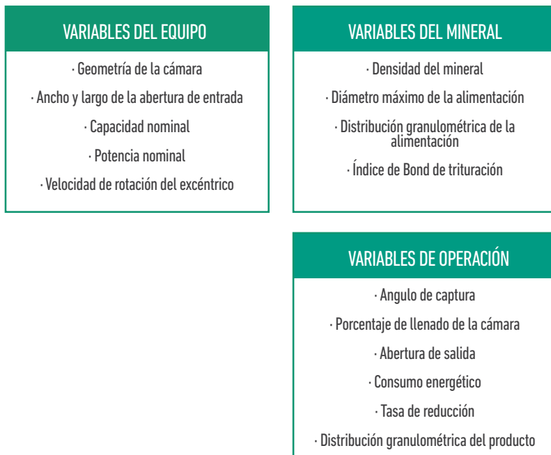
Figura 6.3. Diagrama de funcionamiento de la trituradora de quijadas. Fuente: autores.
