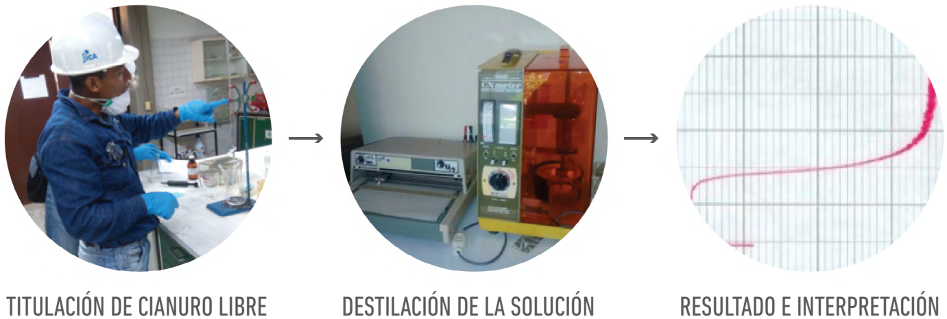
Figura 7.8. Proceso de titulación de cianuro libre y cianurometro utilizado en el laboratorio del SGC sede Cali. Fuente: autores.
