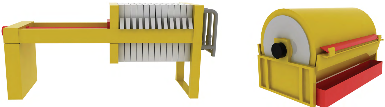
Fotografía 6.11. Modelo de filtro prensa y filtro de tambor. Fuente: autores.
