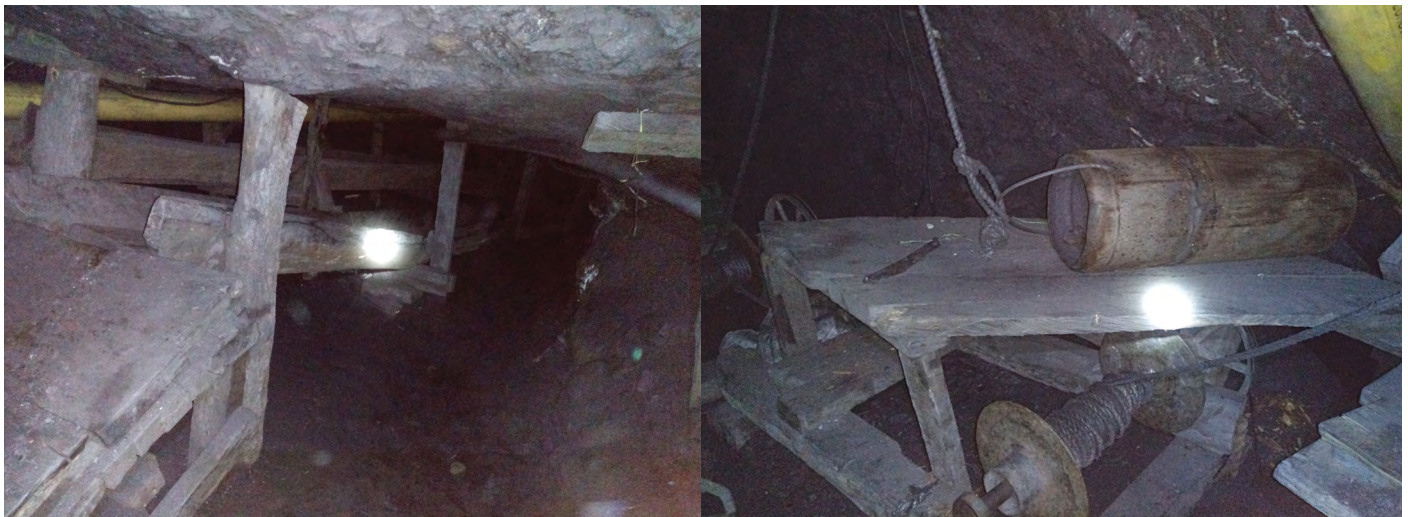
Fotografía 5.4. Sostenimiento con puerta alemana en Almaguer y montaje inactivo para cianuración en el municipio de Bolívar. Fuente: autores.
