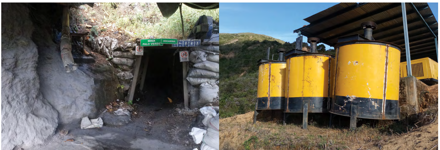
Fotografía 5.4. Sostenimiento con puerta alemana en Almaguer y montaje inactivo para cianuración en el municipio de Bolívar. Fuente: autores.
