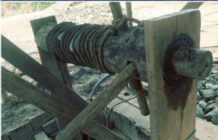
Fotografía 5.9. Malacate para la extracción de mineral. Fuente: Autores.
