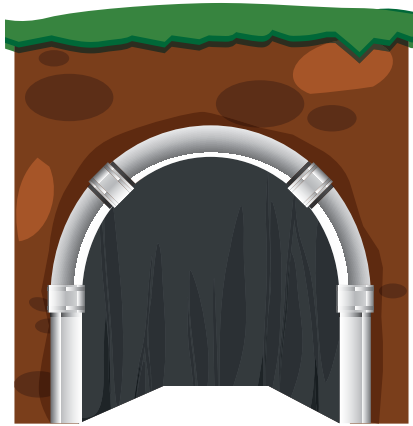
Arco de acero
