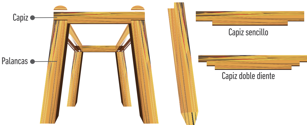
Figura 5.20. Sostenimiento de puerta alemana. Sección mínima 3m 2 . Altura mínima de 1.80m. Fuente: autores.
