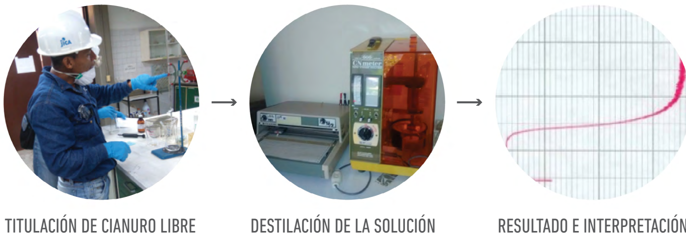
Figura 7.8. Proceso de titulación de cianuro libre y cianurómetro utilizado en el laboratorio del SGC, sede Cali. Fuente: autores.
