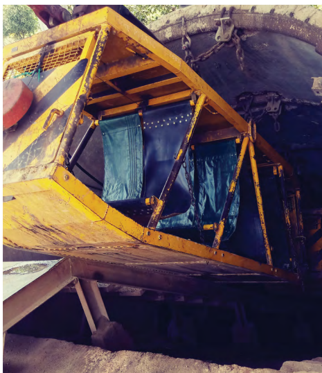
Fotografía 5.19. Tren para transporte de personal en la mina. Fuente: autores.
