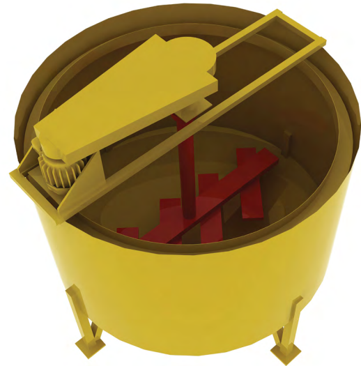
Fotografía 6.13. Modelo de tanque espesador. Fuente: autores.
