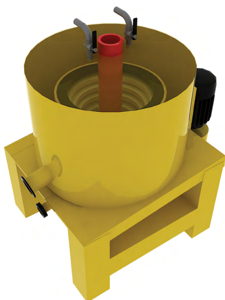
Fotografía 6.9. Modelo de un concentrador centrífugo. Fuente: autores.
