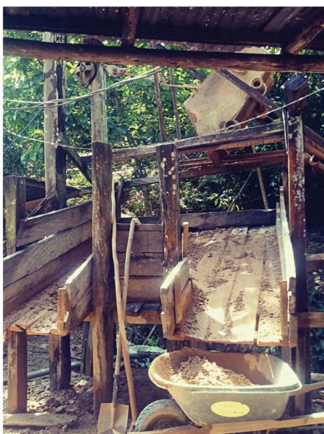
Fotografía 5.5. Tolva para almacenamiento de maerial. Fuente: autores.
