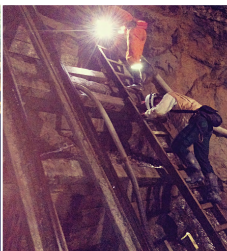
Fotografía 5.17. Acceso por escalera y rieles de conducción de vagón. Fuente: autores.
