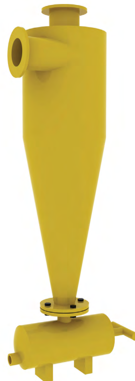
Fotografía 6.6. Modelo de un hidrociclón. Fuente: autores.
