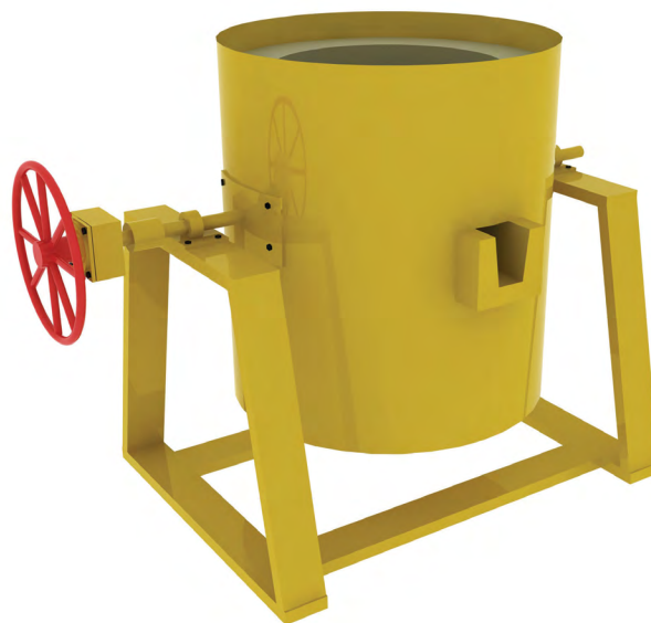
Fotografía 6.12. Modelo de horno con crisol. Fuente: autores.
