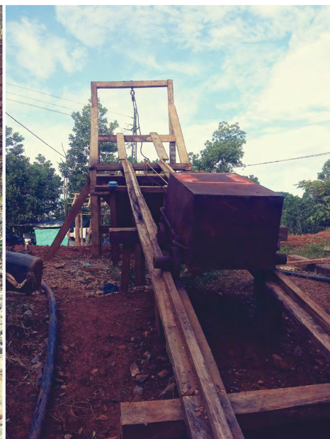
Fotografía 5.11. Vagón para extracción de material. Fuente: autores.
