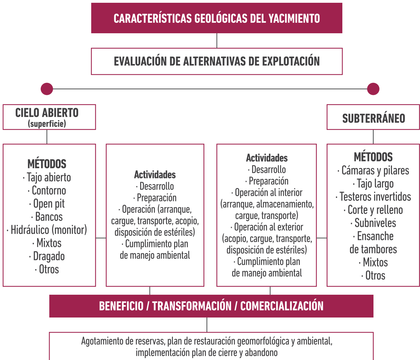
Figura 5.2. Sistema y métodos de explotación. Fuente: modificado de Ministerio de Minas y Energía y Ministerio del Medio Ambiente (2001).
