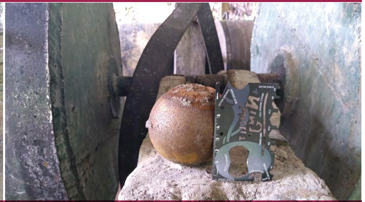
Fotografía 6.21. Detalle de una bola usada en el molino y barriles. Fuente: autores.
