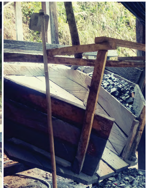
Fotografía 5.3. Tolva para descargue de mineral. Fuente: autores.
