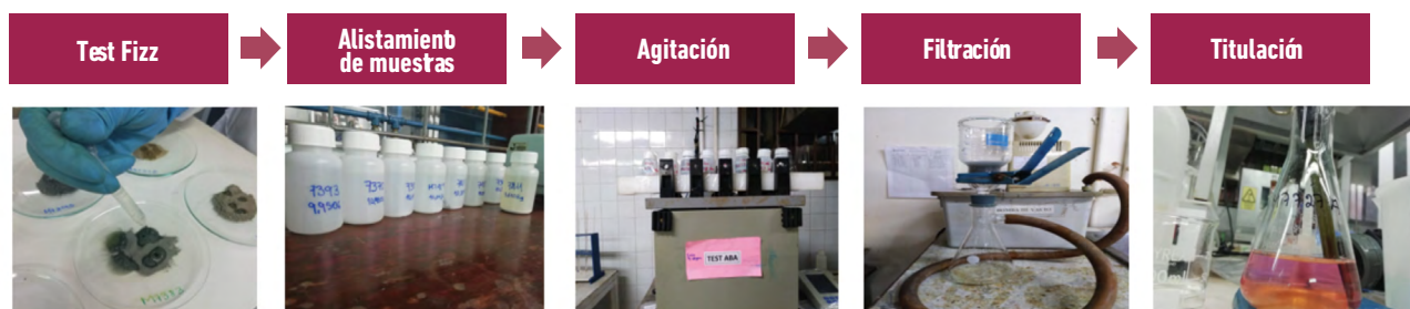
Figura 7.26. Determinación de pH y carbonatos totales en muestras de relaves de las plantas de beneficio de Zaragoza. Fuente: autores.
