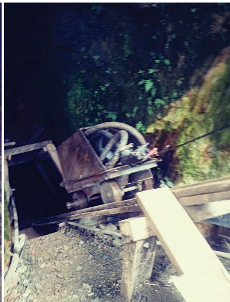
Fotografía 5.2. Vagón con malacate para transporte de material. Fuente: autores.
