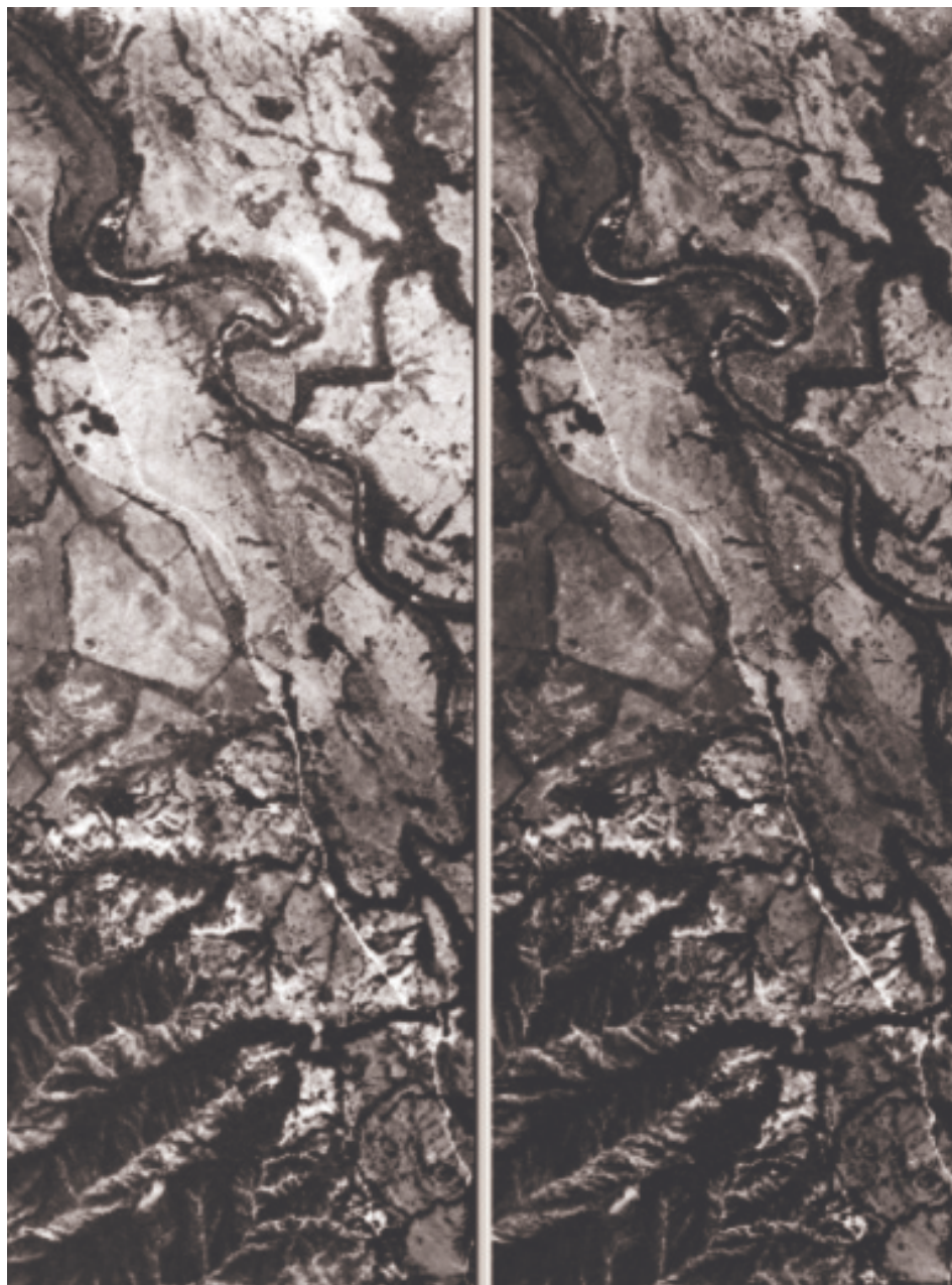
Figura 10. Estereopar de las fotografías aéreas N.ºs 29 y 30 línea de vuelo N.º 1273, escala aproximada de las fotografías 1:21.000, en el cual se registra el trazo de la Falla de Ibagué.
