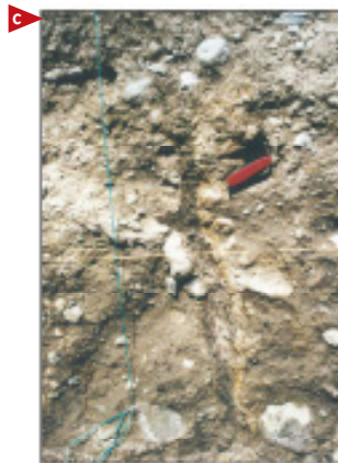
Figura 50. b. Detalle de la grieta 1 que afecta el Nivel N1. c. Detalle de la grieta 2 que afecta los niveles N1, N2 y N7. La materia orgánica que rellena las grietas 1 y 2 fue muestreada para datación 14C con la técnica AMS.
