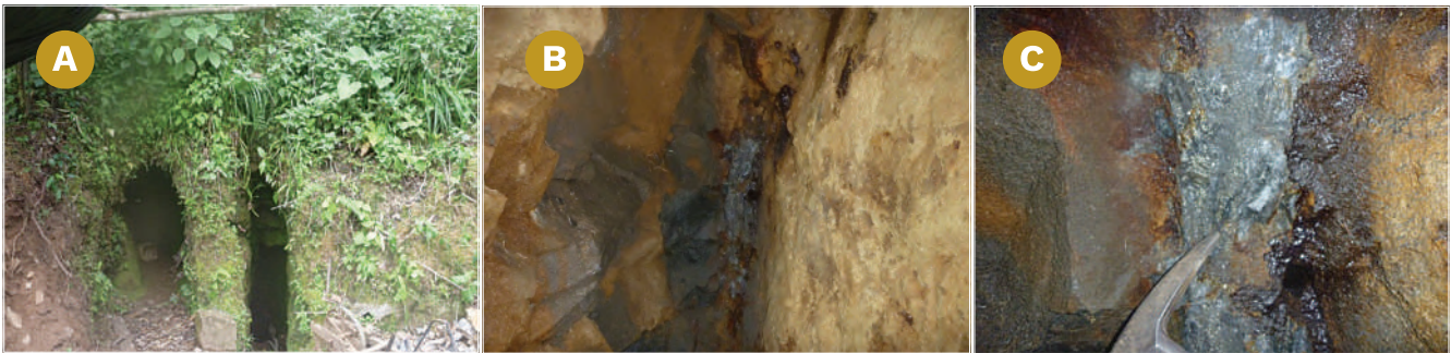
Fotografía 3.14. A) Bocamina de Manga (N: 1232126, E: 1113619, 2.057 m. s. n. m.), azimuth: 260°. B) Estructura principal de la mina Manga. C) Mineralización de la mina Manga. Agregado masivo de sulfuros
