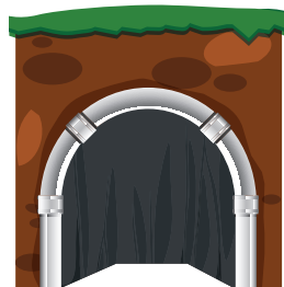
Arco de acero
