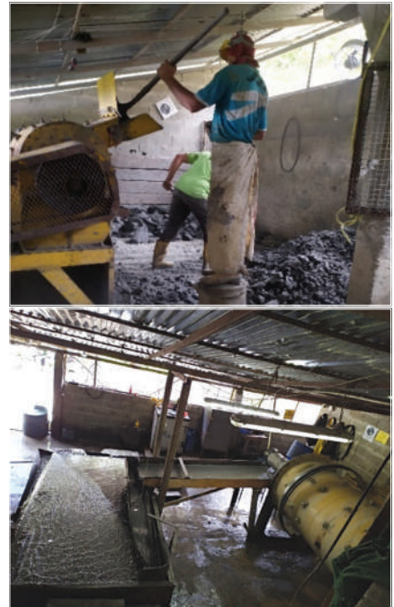
Fotografía 6.16. Trituradora de martillos y Molino de bolas con mesa primaria, mina El Apique
