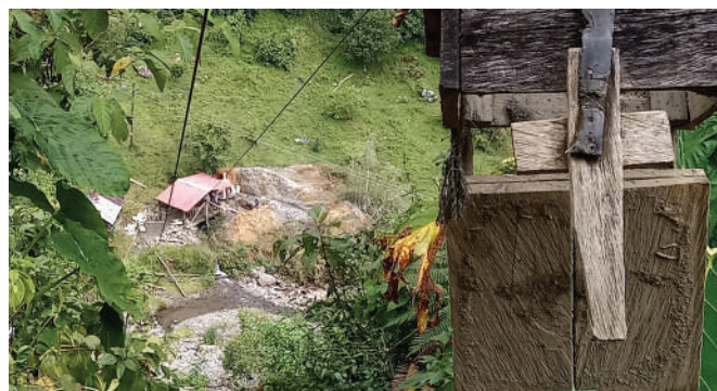
Fotografía 5.1. Garrucha para transporte de mineral desde la bocamina hasta el molino de arrastre. Sector El Hoyo-Corregimiento El Cerro
