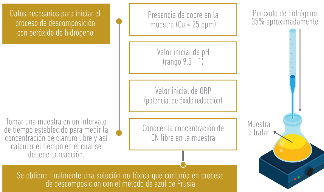
Figura 7.11. Diagrama de descomposición de cianuro complejo mediante el método azul de Prusia
