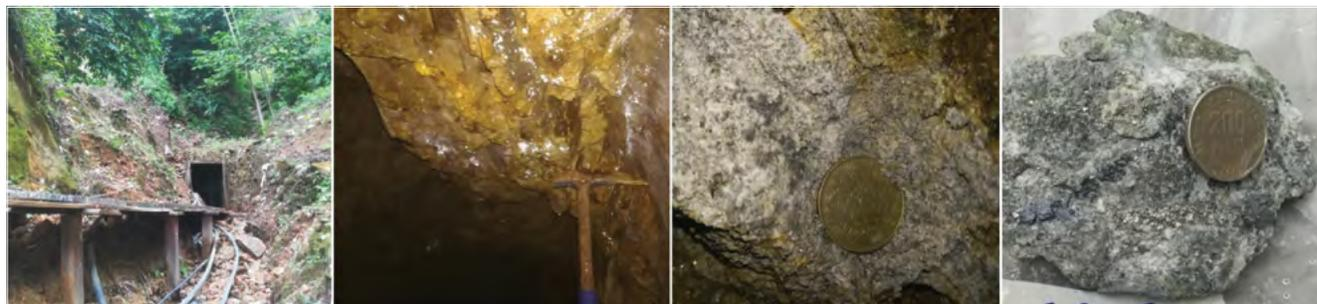
La zona de falla mineralizada en el frente actual de explotación tiene un espesor de 1,4 metros. Se caracteriza por presentar roca molida con arcillas y venas en los respaldos, piso y techo, con pirita y marcasita de tamaño de grano fino. Hacia el centro de la estructura, la mineralización es de sulfuros diseminados.
