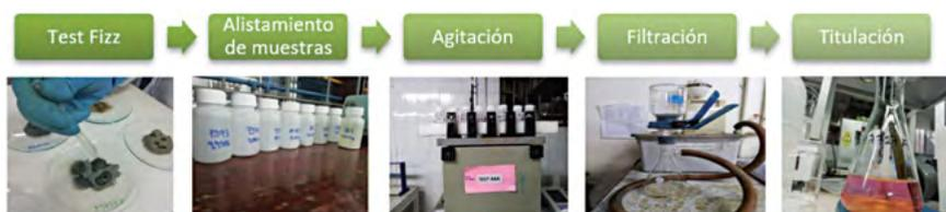
El potencial de generación de drenaje ácido se establece a partir del resultado del potencial de neutralización, cuyo procedimiento se muestra en la figura 7.56, y del potencial de acidez, que se determina a partir de la
