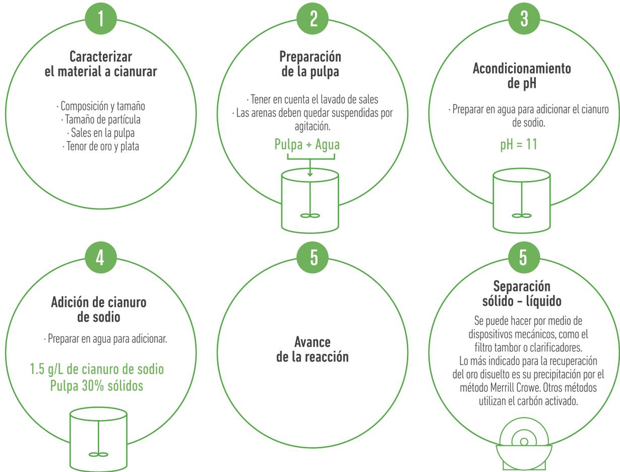
Hay otros métodos para separar la solución rica de las arenas al finalizar la cianuración. El espesador es un sedimentador que entrega solución clarificada por rebose y una pulpa sedimentada con una concentración de sólidos por peso que puede ser mayor del 80%. Esta pulpa puede impulsarse a un filtro prensa, filtro de tambor, o llevarse a un tanque percolador para recuperar una solución rica y descomponer compuestos ambientalmente dañinos.
