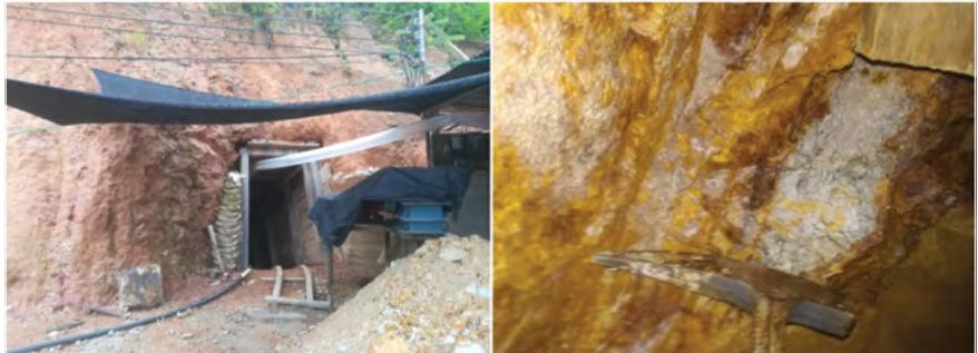
Fotografía 3.23. Estructura de mina Ancha: túnel de acceso, estructura mineralizada y roca encajante (toba de cristales)
