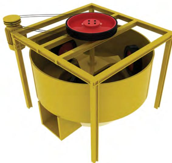
**El molino chileno es una máquina versátil que permite triturar, moler y concentrar el oro grueso. Para las asociaciones es muy útil, debido a que cada minero puede trabajar su material sin que exista mezcla con materiales de diferentes minas**
