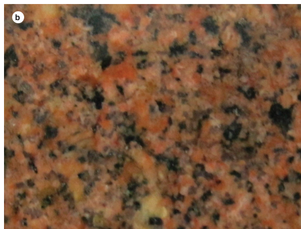
Figura 2. Aspecto macroscópico de la Cuarzomonzonita de Los Naranjos a) Cuarzomonzonita de color blanco y rosado moteado de negro con textura fanerítica granular. b) Aspecto macroscópico de un sienogranito.
